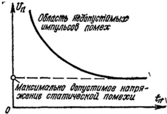
Рис. 2. Характеристика динамической помехоустойчивости логической микросхемы
