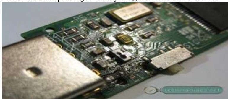
Рисунок 4 - Внешний вид флэш-накопителя со сгоревшим стабилизатором
