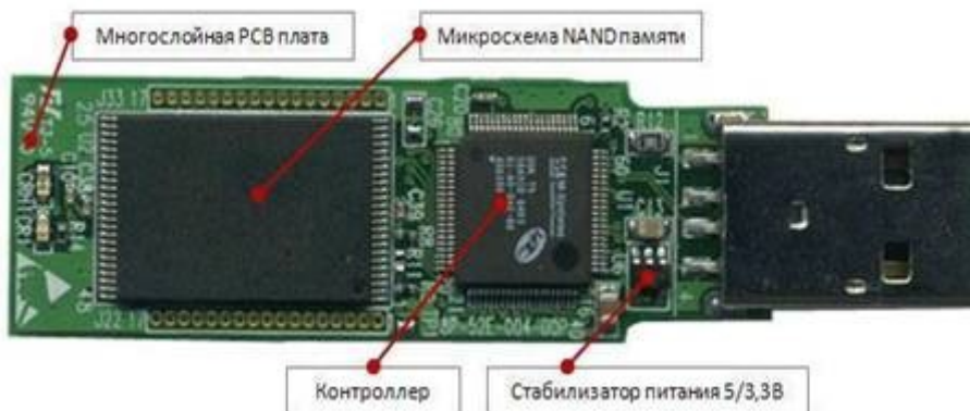
Рисунок 1 - Расположение основных элементов флэш-накопителя
