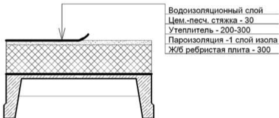
Рисунок 3— комплексная плита покрытия
