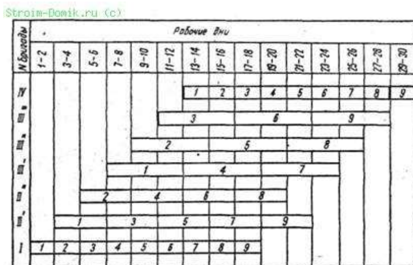
Рис. 4. График производства работ поточным методом с кратным ритмом два, четыре и шесть дней
