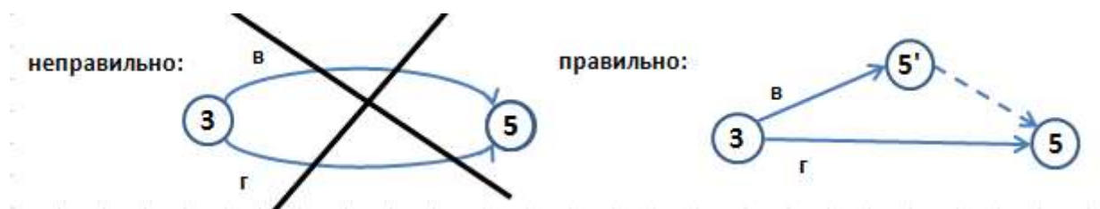
Рис. 7. Изображение работ имеющих одно начальное и конечное событие Если выполнение какой-либо работы (например, «е») возможно только после получения совокупного результата двух или более параллельно выполняемых работ (например, «в» и «г»), а выполнение другой работы (например, «д») – после получения результата только одной из них (например, «в»), то в сетевом графике необходимо ввести дополнительное событие и фиктивную работу (рис. 8).
