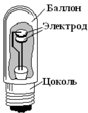
Рисунок 1. Конструкция газоразрядного индикатора
