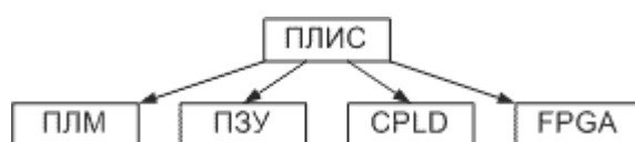
Рисунок 1. Классификация программируемых логических интегральных схем (ПЛИС)
