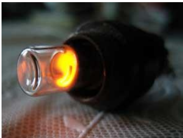
Рисунок 2. Внешний вид газоразрядного индикатора в момент свечения
