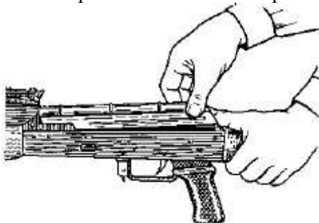
Рис. 13. Отделение крышки ствольной коробки
