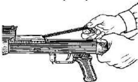
Рис. 14. Отделение возвратного механизма
