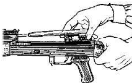
Рис. 15. Отделение затворной рамы с затвором
