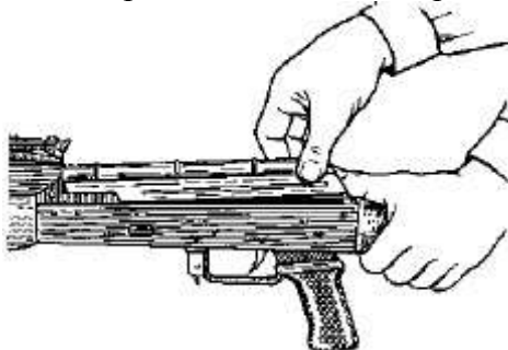
Рис. 13. Отделение крышки ствольной коробки
