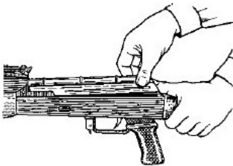
Рис. 13. Отделение крышки ствольной коробки
