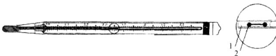
Рис. 1.1. Спиртовой минимальный термометр: 1 – капилляр; 2 – штифт-указатель
