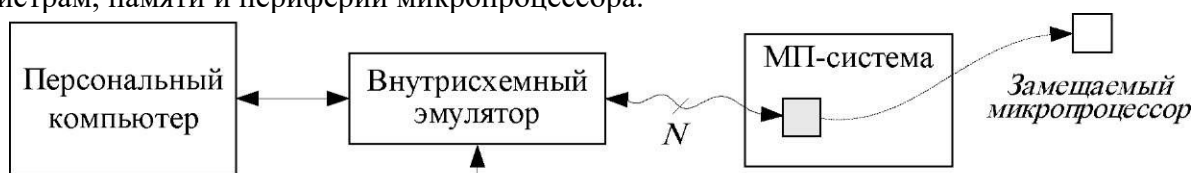
Рис. 33.2. Отладка с помощью внутрисхемного эмулятора N - количество выводов процессора
