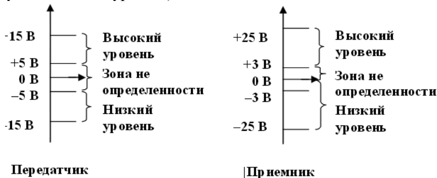
Рис. 15. Уровни сигналов RS-232C на передающем и принимающем концах линии связи
