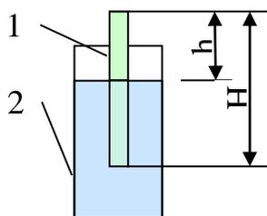
Рис.10. Определение средней плотности древесины в полевых условиях
