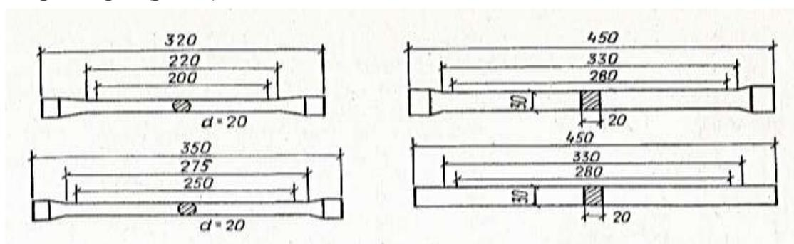
Рис 1. Образцы стали для испытания на растяжение.
