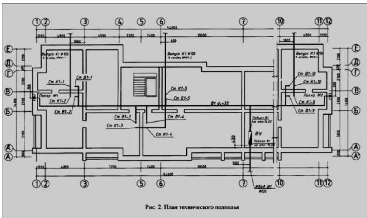
трубопровод, подающий воду в здание. На сетях с нижней разводкой их размещают в подпольях, подвалах и технических этажах или на первом
