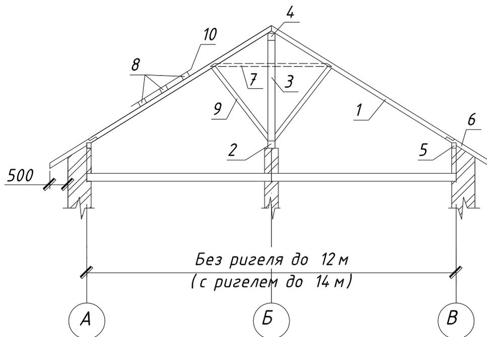
Рисунок 1 - Сечение скатной крыши по наслонным стропилам
