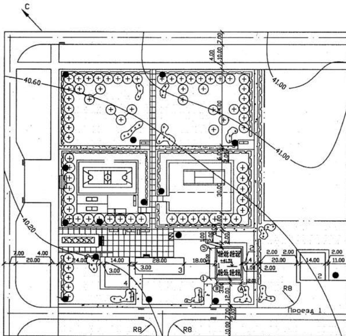
Генеральный план — это вид сверху на участок проектируемого здания, дающий возможность оценить планировочное решение застройки, взаимосвязь отдельных ее частей, а также характер благоустройства территории. В состав чертежей генерального плана входят: разбивочный план, план организации рельефа, план земляных масс, сводный план инженерных сетей, план благоустройства территории, выносные элементы.
