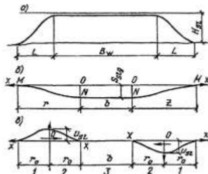
Рис. 2. Общий характер развития на замачиваемой площади (а) просадки поверхности грунта (б) и горизонтальных перемещений грунта (в) 1, 2, 3 — участки горизонтального разуплотнения, уплотнения и нейтральной зоны
