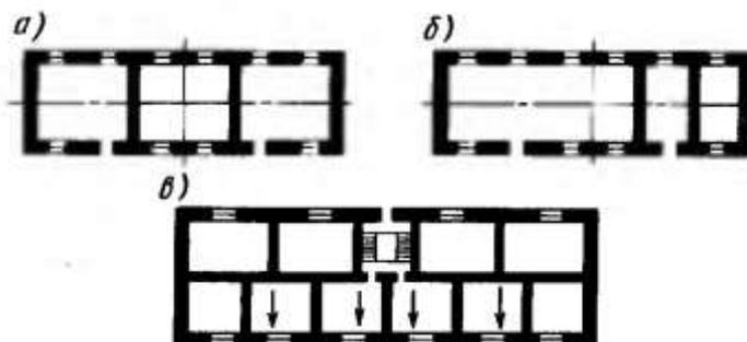
**Рис. 30.2.** Схема расположения жесткости в плане здания:
