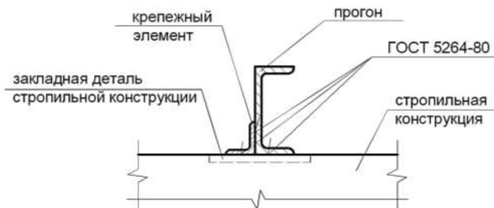
Прогоны пролетом 6 м изготавливаются сплошными из одиночного прокатного швеллера №20 – 24. Прогоны пролетом 12 м представляют собой решетчатую (сквозную) конструкцию. Верхний пояс прогона образован из двух прокатных швеллеров №10 – 16, а нижний пояс и раскосы – из гнутых швеллеров.
