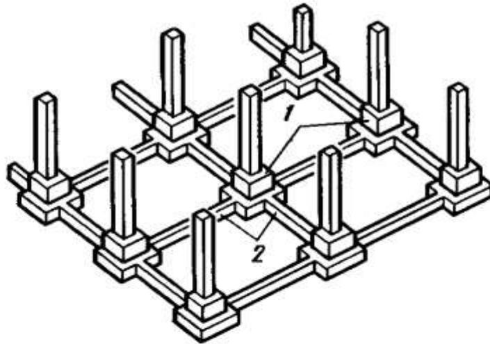
Рис. 30.4. Схема столбчатых фундаментов с антисейсмическими связями:
