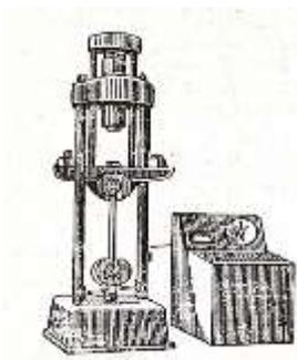
Рисунок 2. Общий вид универсальной испытательной машины УММ - 50.
