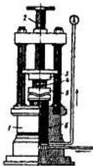
Схема гидравлического пресса для испытания на сжатие: 1 - станина; 2 - винтовое приспособление для зажима образца; 3 - верхняя опорная плита; 4 - испытуемый образец; 5 - нижняя опорная плита с шаровой поверхностью; 6 - поршень
