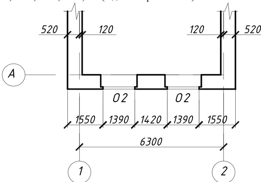
Рисунок 12- Расчет простенков
