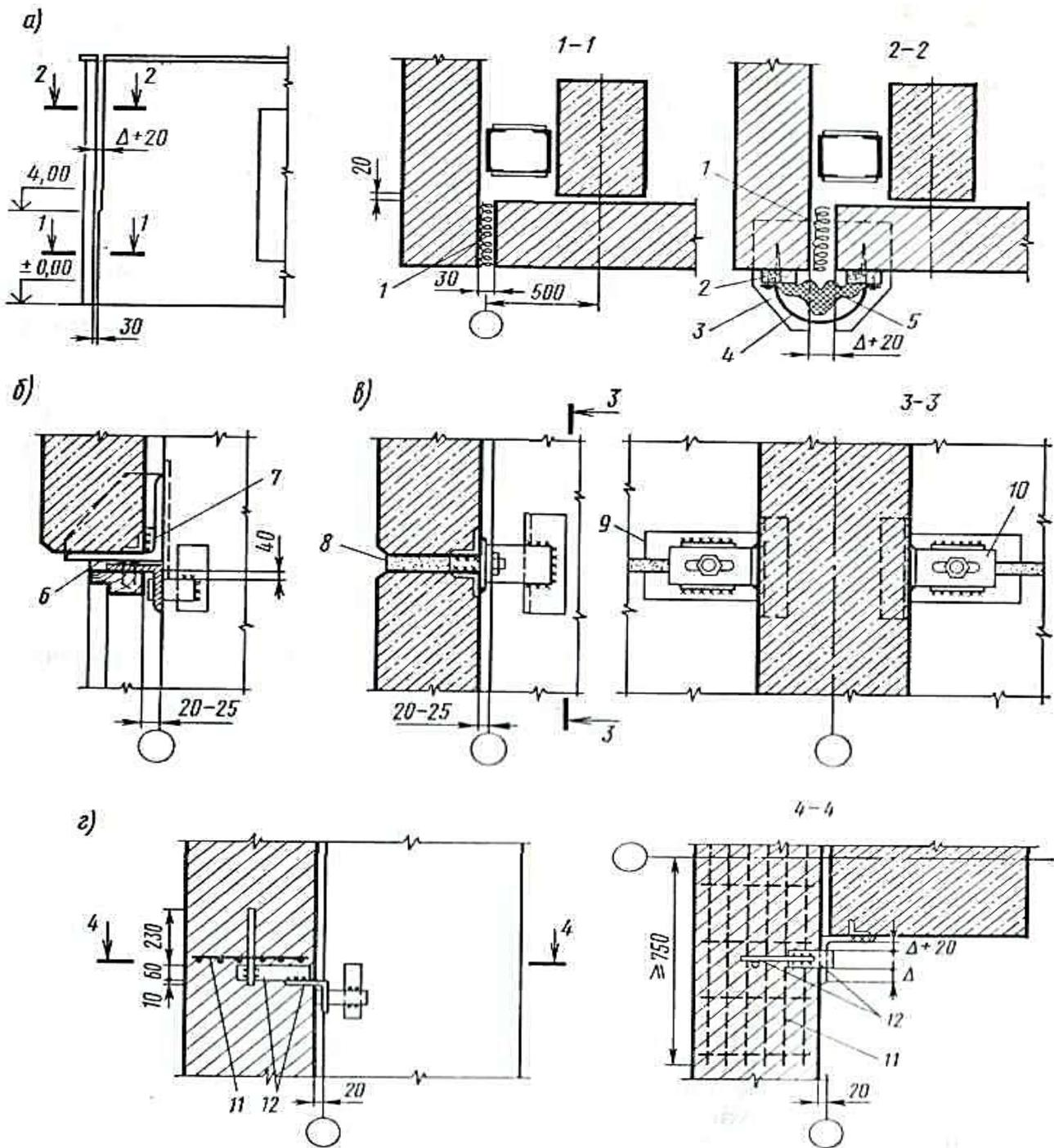
Рис.3. Детали стен сейсмостойких зданий:
