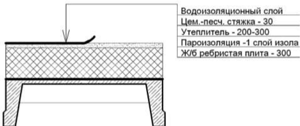
Рисунок 3— комплексная плита покрытия
