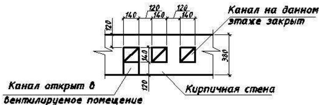
Рисунок 1 – Устройство вентиляционных каналов
