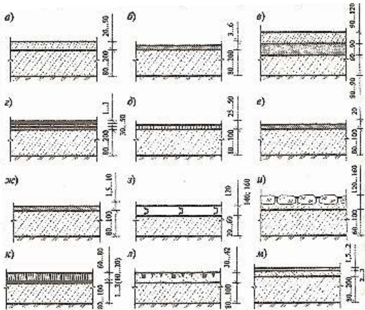
а – бетонные; б – металлоцементные; в – жаростойкие бетонные; г – силикатные; д – асфальтобетонные; е – полимерцементобетонные; ж – полимерные наливные; з – сборные из комплексных бетонных плит; и – брусчатые каменные; к – из торцевой деревянной шашки; л – из металлических плит; м – из линолеума
