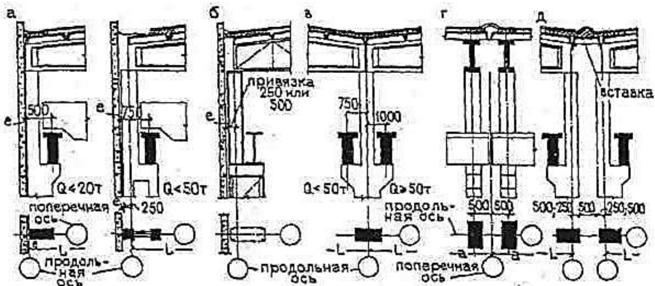
Рисунок 20 - Привязка элементов к разбивочным осям зданий, оборудованных кранами: а- железобетонные колонны с шагом 6 или 12 м; б - стальные колонны; в - средние ряды колонн; г - поперечный температурный шов; д - продольный температурный шов.
