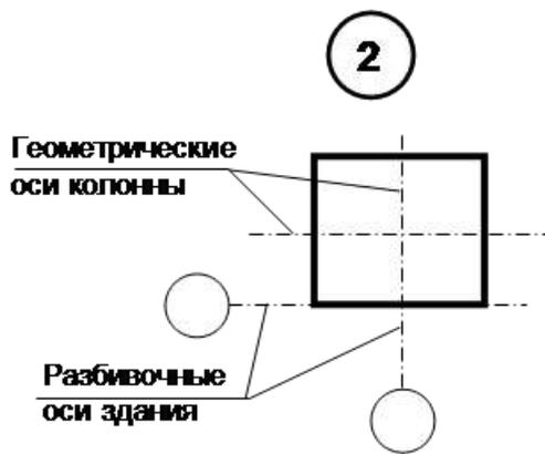
Рис. 3.4. Нулевая привязка
