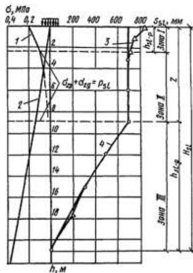
Рис. 1. Зоны деформации просадочного грунта в основании фундамента
