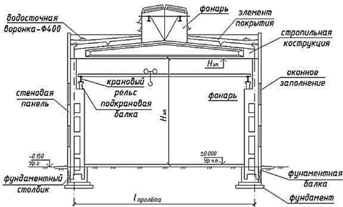
Рисунок 2. Элементы каркаса промздания.
