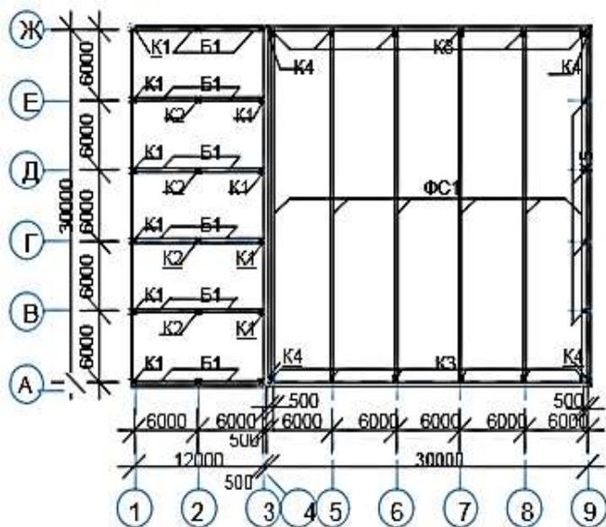
Рисунок 1. Схема расположения колонн, балок и ферм покрытия
