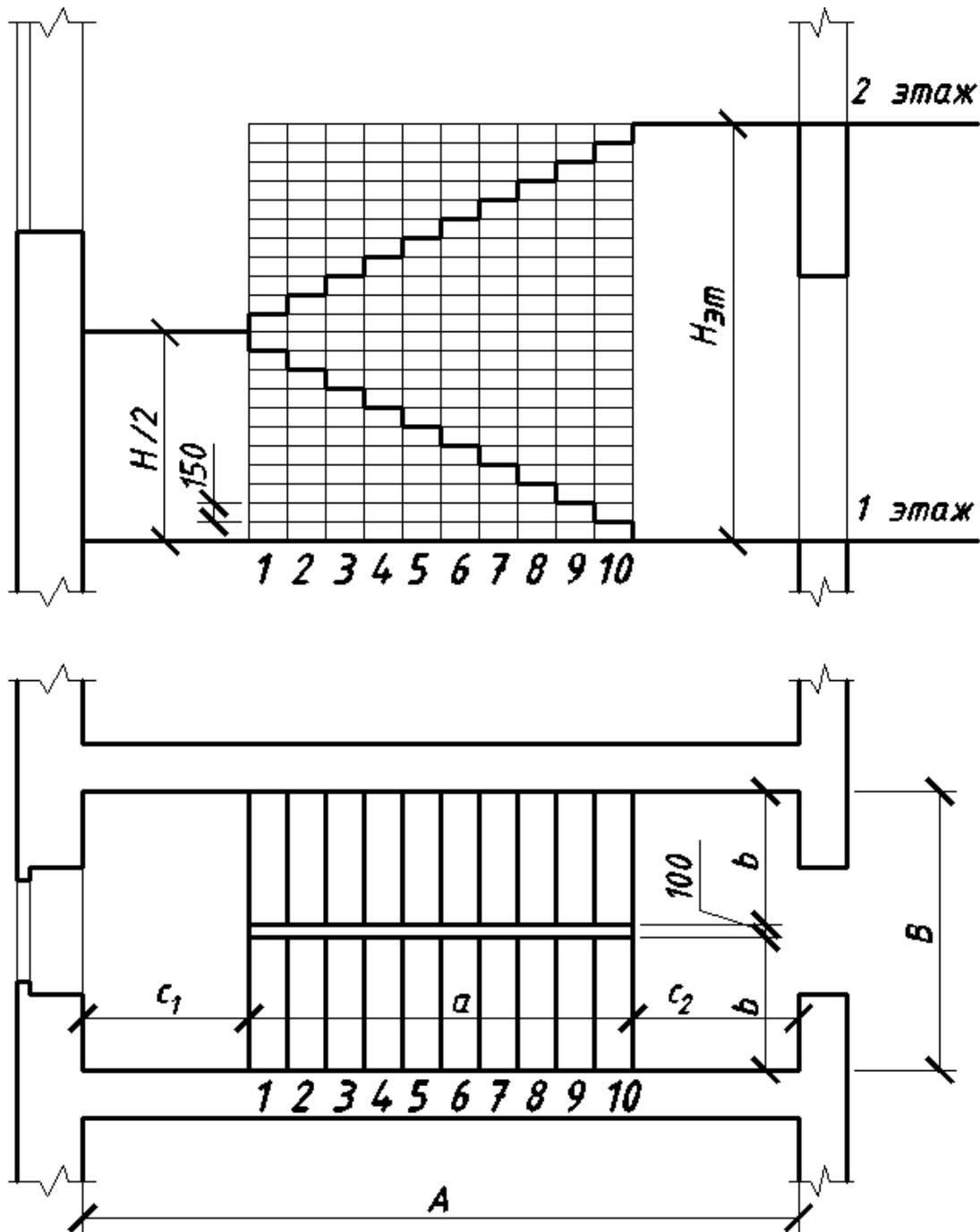
одной и через полученные точки проводим вертикальные прямые. По полученной сетке вычерчиваем профиль лестницы в М1:50.
