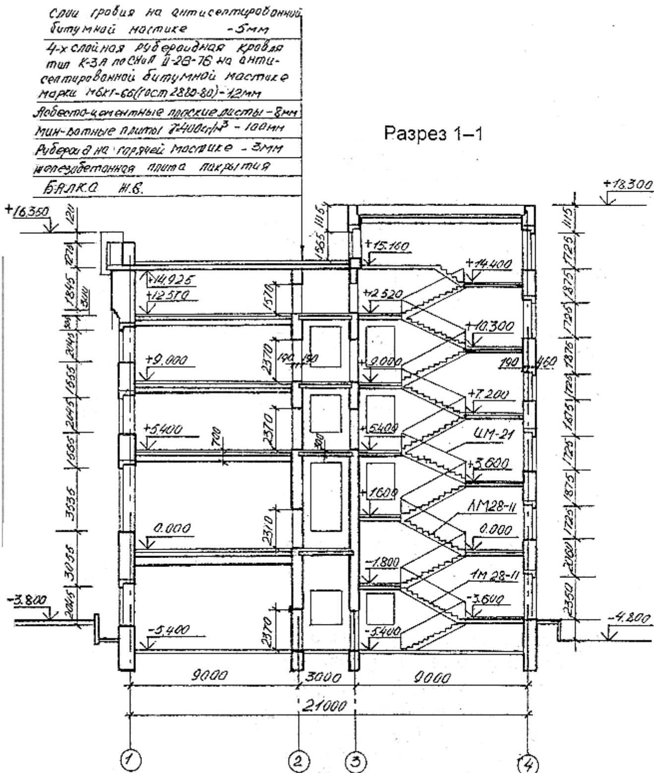
Рисунок 2. Пример выполнения разреза многоэтажного общественного здания
