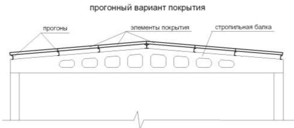
2. Комплексные плиты покрытия имеют те же размеры, что и ребристые; они поступают с завода в полной готовности с уложенной по плите пароизоляцией, теплоизоляцией, стяжкой и кровлей. После укладки настила заделывают швы, укладывают полосу пароизоляции над швом, теплоизоляцию, стяжку, дополнительный слой кровельного материала; после этого по всей площади покрытия устраивают верхний слой рулонного кровельного материала.
