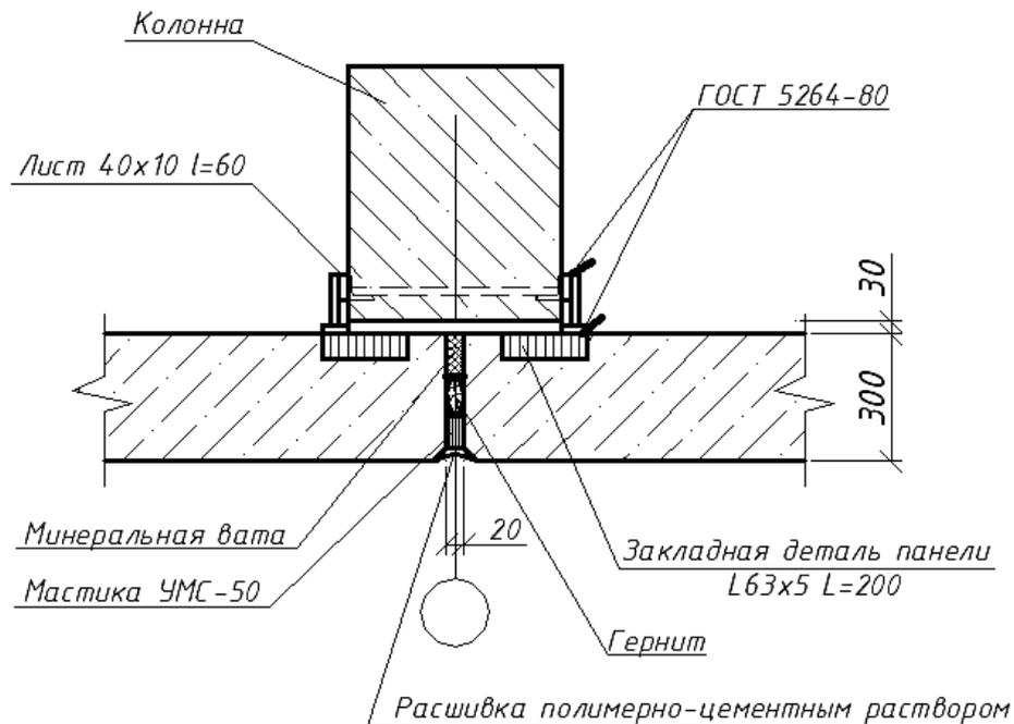
Рисунок 1- узел крепления стеновой панели к колонне каркаса при помощи
