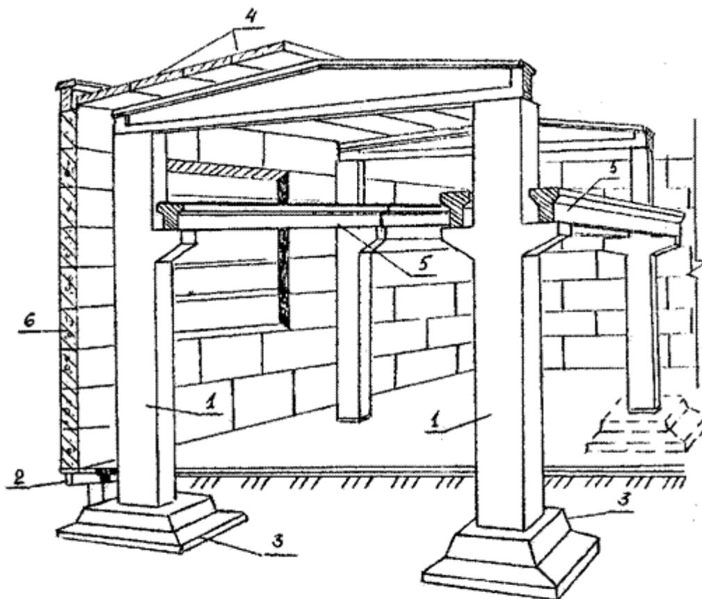
**Рис.3.3. Каркас одноэтажного промышленного здания:**
