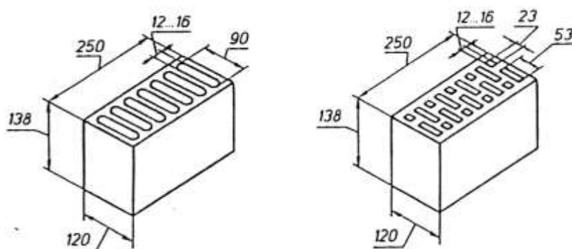
Рис. 2. Пустотелые керамические камни а) с 7 , б) с 18 пустотами
