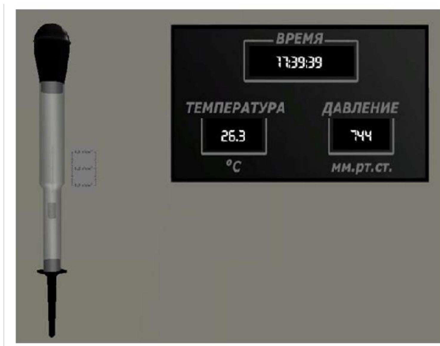
Рис. 4.1. Денсиметр после замера плотности электролита
