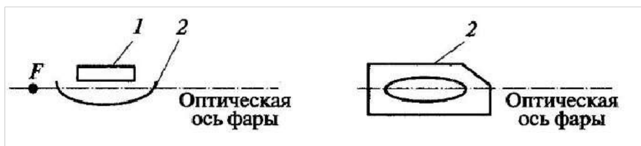
Рис. 6.2. Размещение нити накала ближнего света в фаре европейской системы светораспределения 1 — нить ближнего света; 2 — корытообразный экран
