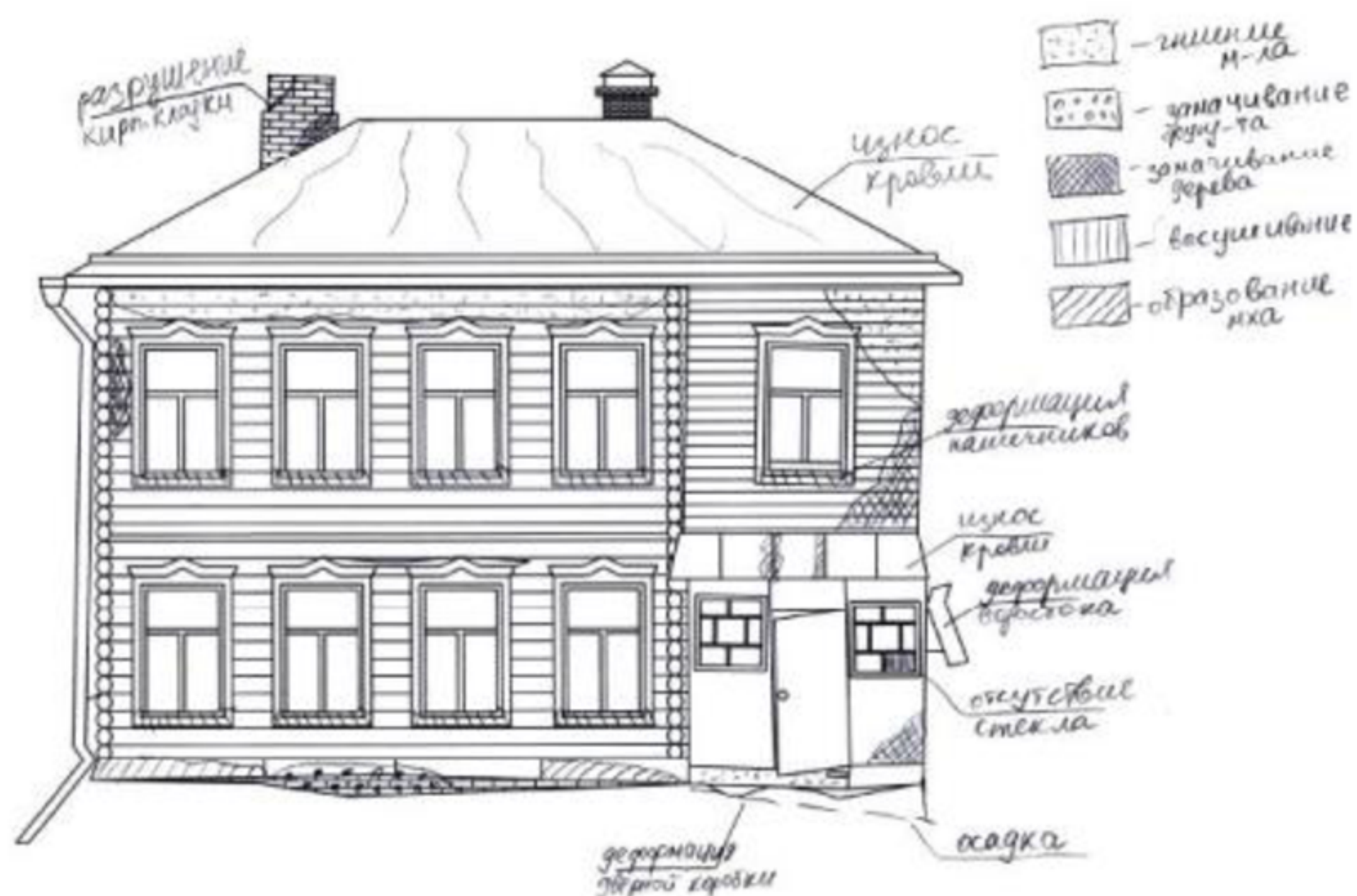
Рисунок 3 – Дефектная карта фасада
