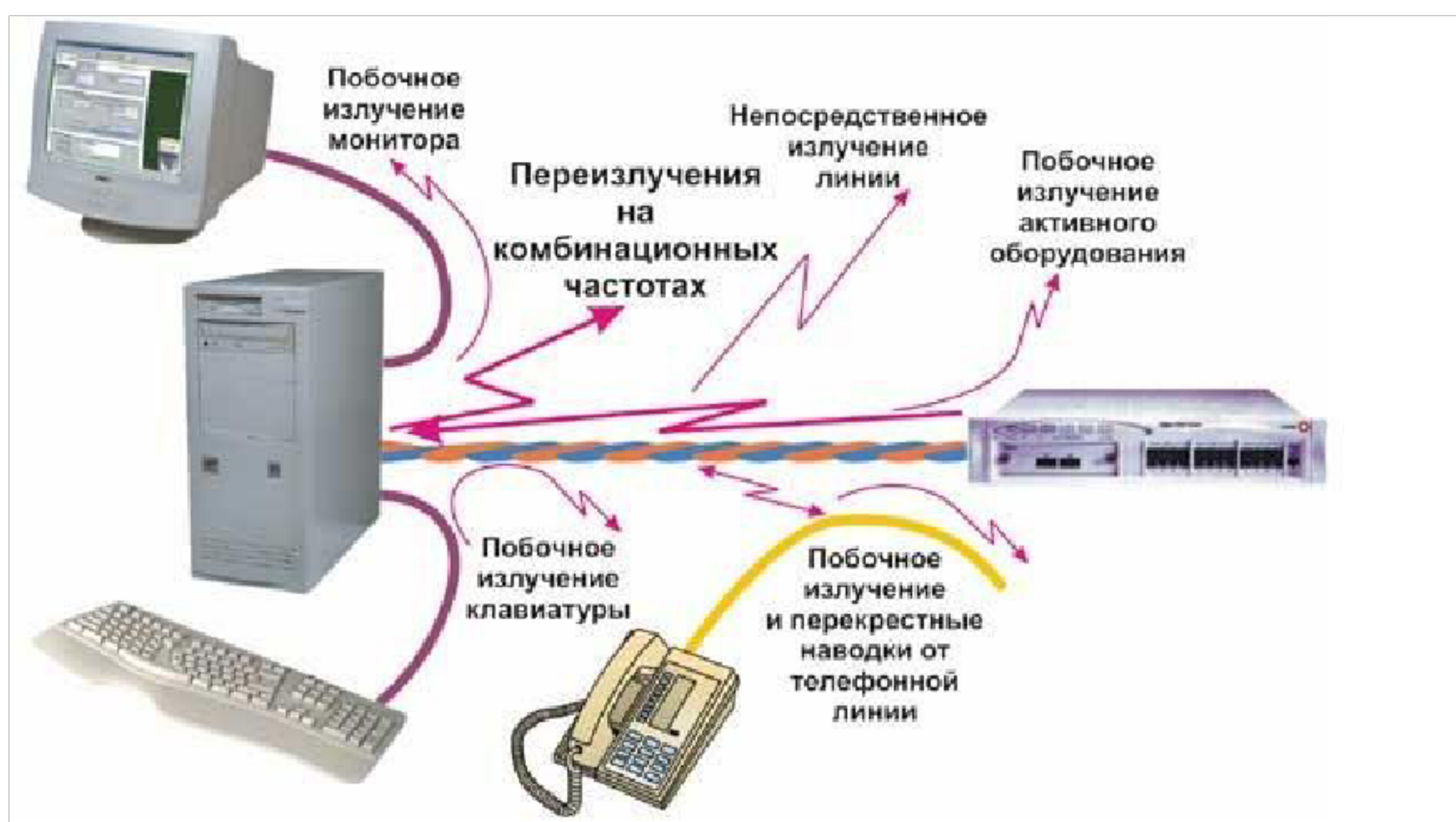
Рис 3.1 Основные источники возникновения ПЭМИ при работе СВТ
