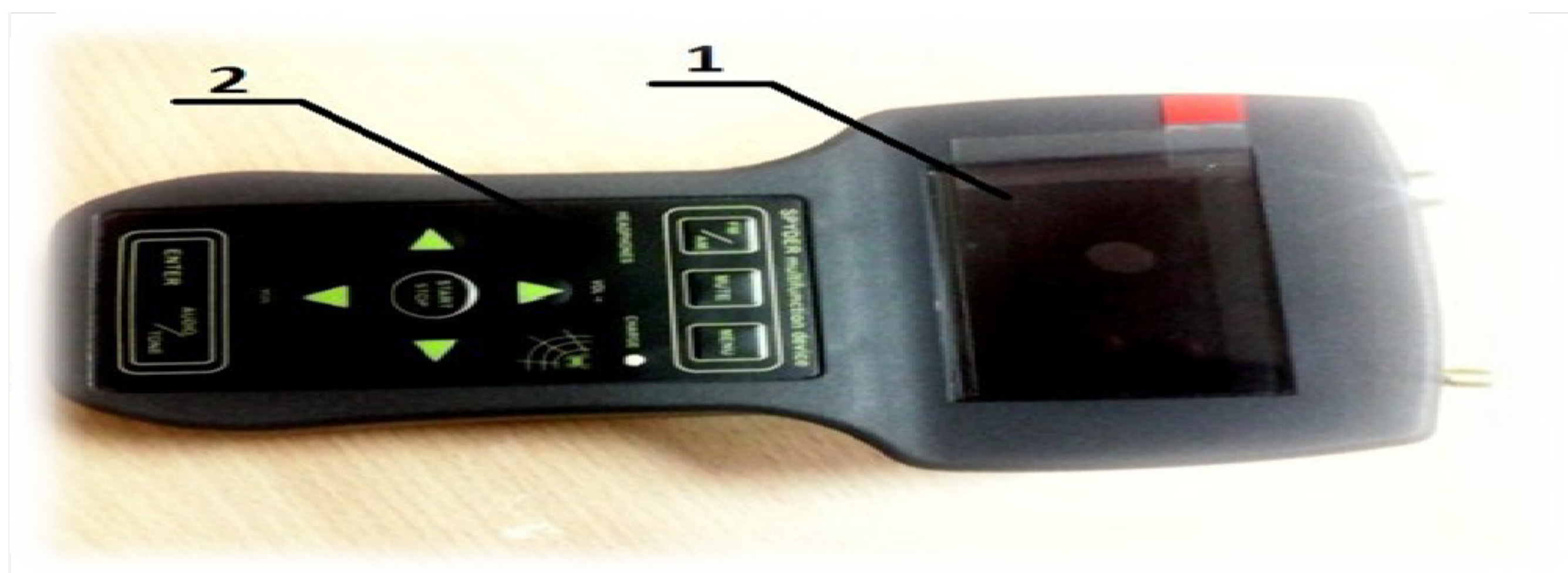
Рисунок 2.6 – Многофункциональный поисковой прибор «Спайдер» (лицевая часть).
