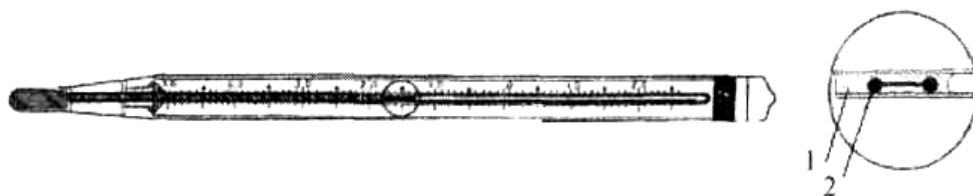
Рис. 1.1. Спиртовой минимальный термометр: 1 – капилляр 2 – штифт-указатель
