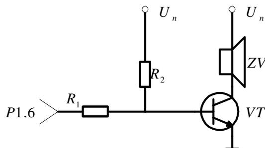
Рисунок 6.8 – Схема звуковой индикации
