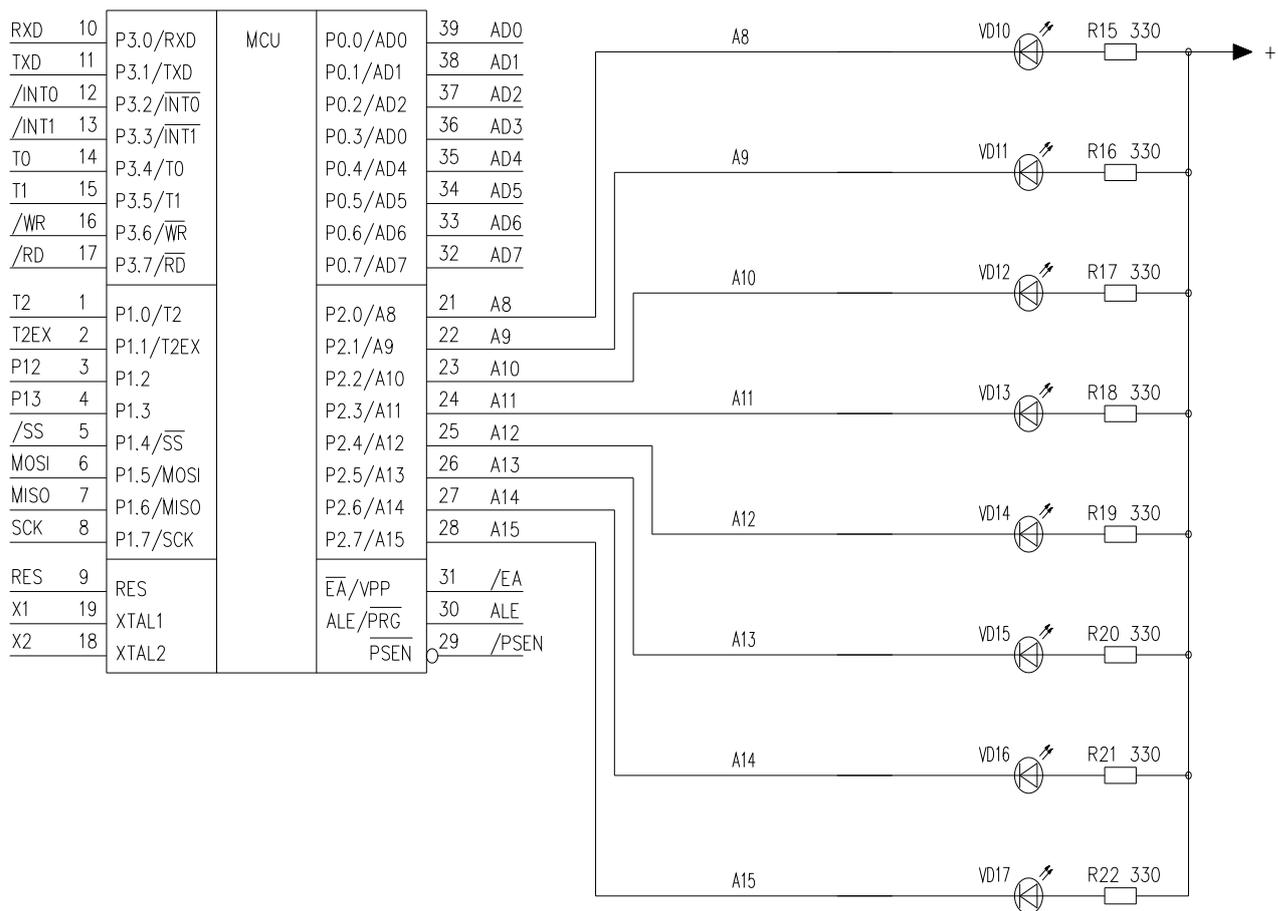
Рисунок 1.6 – Схема соединения светодиодов подсветки с МК
