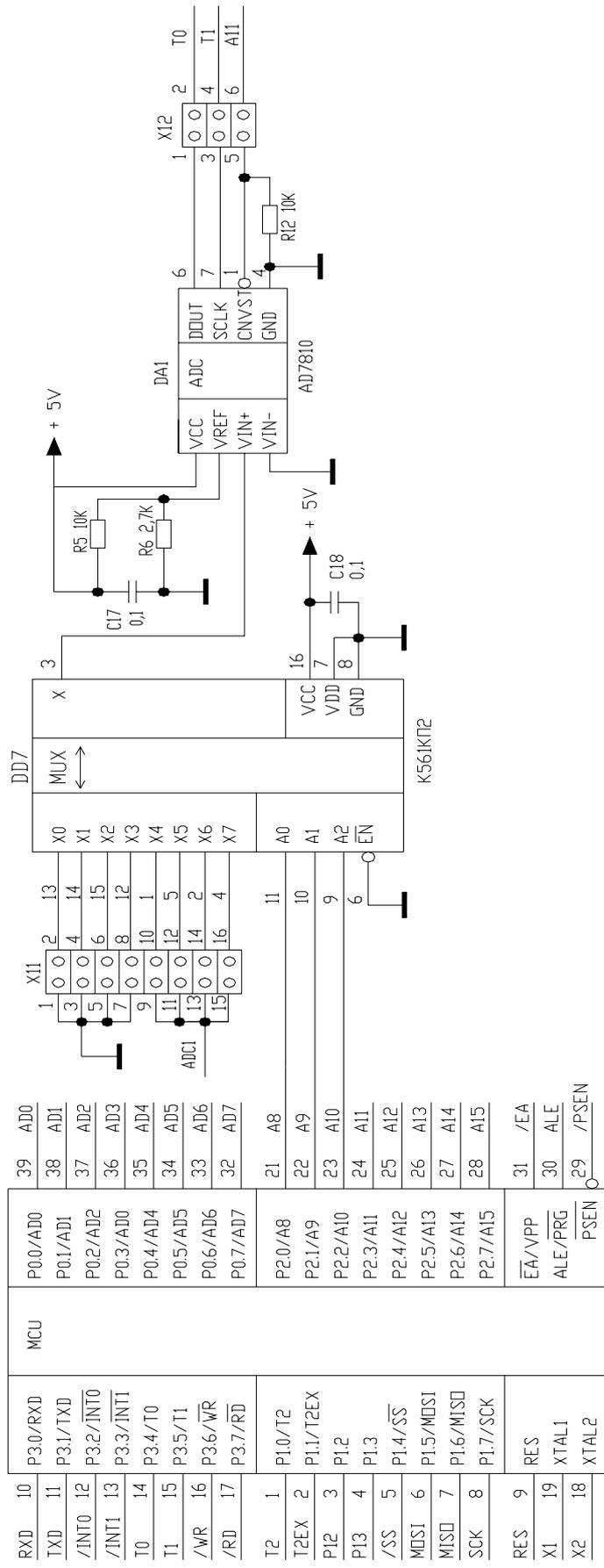
Рисунок 5.4 – Схема измерительного канала
