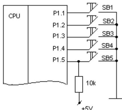
Рисунок 4.1 – Схема подключения кнопочной станции к МК
