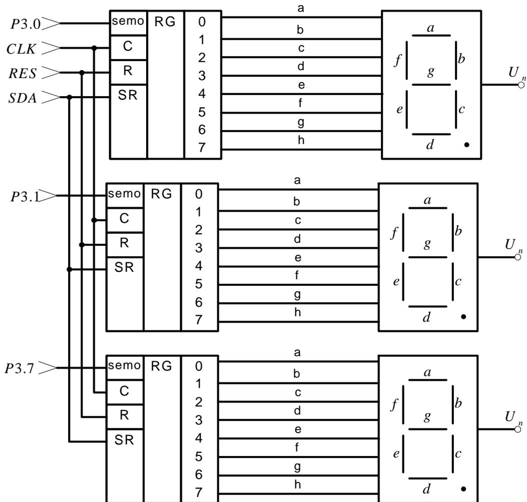
Рисунок 6.10 – Схема ЦОУ
