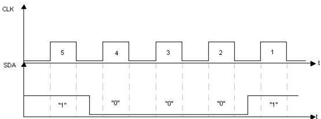
Рисунок 2.2 – Временная диаграмма последовательной передачи данных
