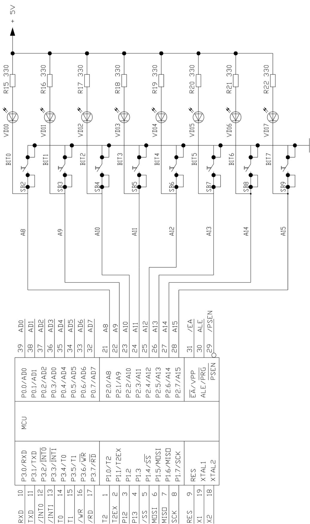
Рисунок 1.7 – Схема соединения кнопочной станции с МК
