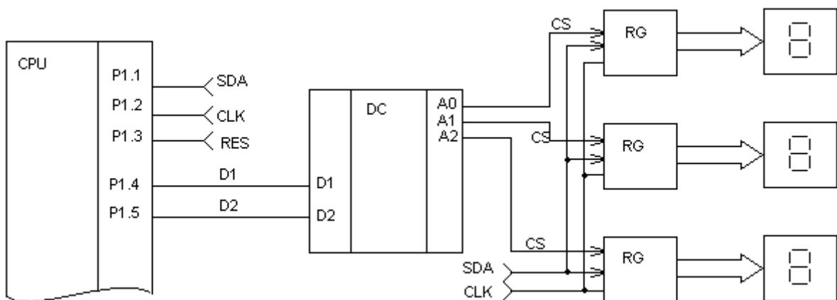
Рисунок 3.1 – Схема включения ЦОУ на семисегментных индикаторах
