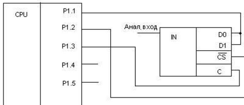
Рисунок 5.3 – Схема включения АЦП в цепь МК
