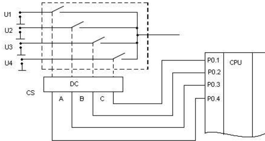
Рисунок 5.1 – Схема включения коммутатора в цепь МК с параллельным управлением
