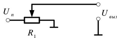
Рисунок 6.5 – Измерительный канал температуры уставки
