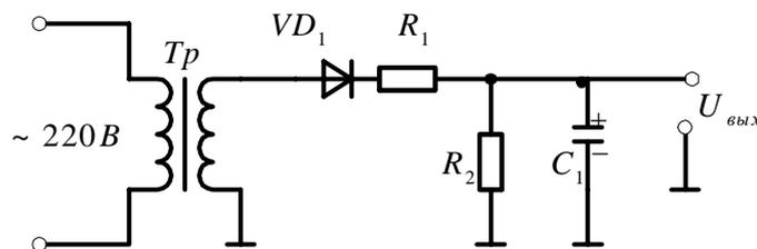
Рисунок 6.2 – Канал измерения напряжения
