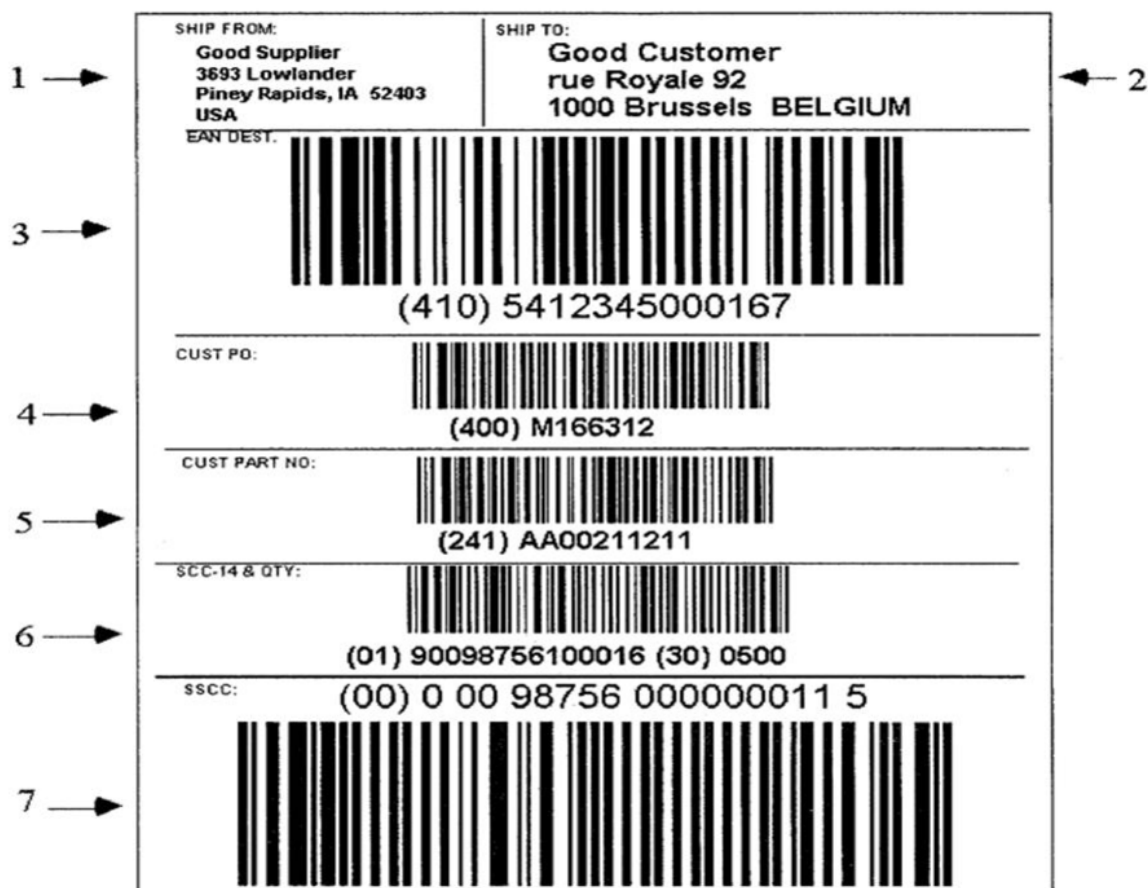
Рис. 2.12. Расширенная этикетка с идентификатором UCC/EAN: 1 – текстовая информация об отправителе; 2 – текстовая информация о получателе; 3 – ссылка к базе данных перевозчика; 4 – ссылка к базе данных получателя; 5, 6 – дополнительные данные (241 – номер, присвоенный получателем), 01 – глобальный номер товара EAN, 30 – количество); 7 – уникальный идентификатор транспортируемой единицы в символической UCC/EAN-128.
