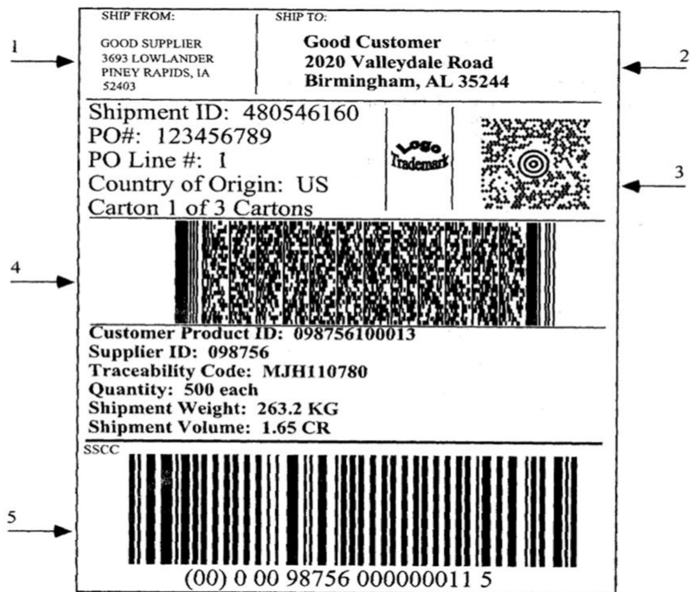
Рис. 2.14. Расширенная этикетка, содержащая уникальный идентификатор транспортируемой единицы в символике UCC/EAN-128 и дополнительные данные торговых партнеров в двумерных символах: 1 – текстовая информация об отправителе; 2 – текстовая информация о получателе; 3 – двумерный символ для сортировки и/или отслеживания груза перевозчиком; 4 – двумерный символ с данными получателя или заказчика; 5 – уникальный идентификатор транспортируемой единицы в символике UCC/EAN-128.
