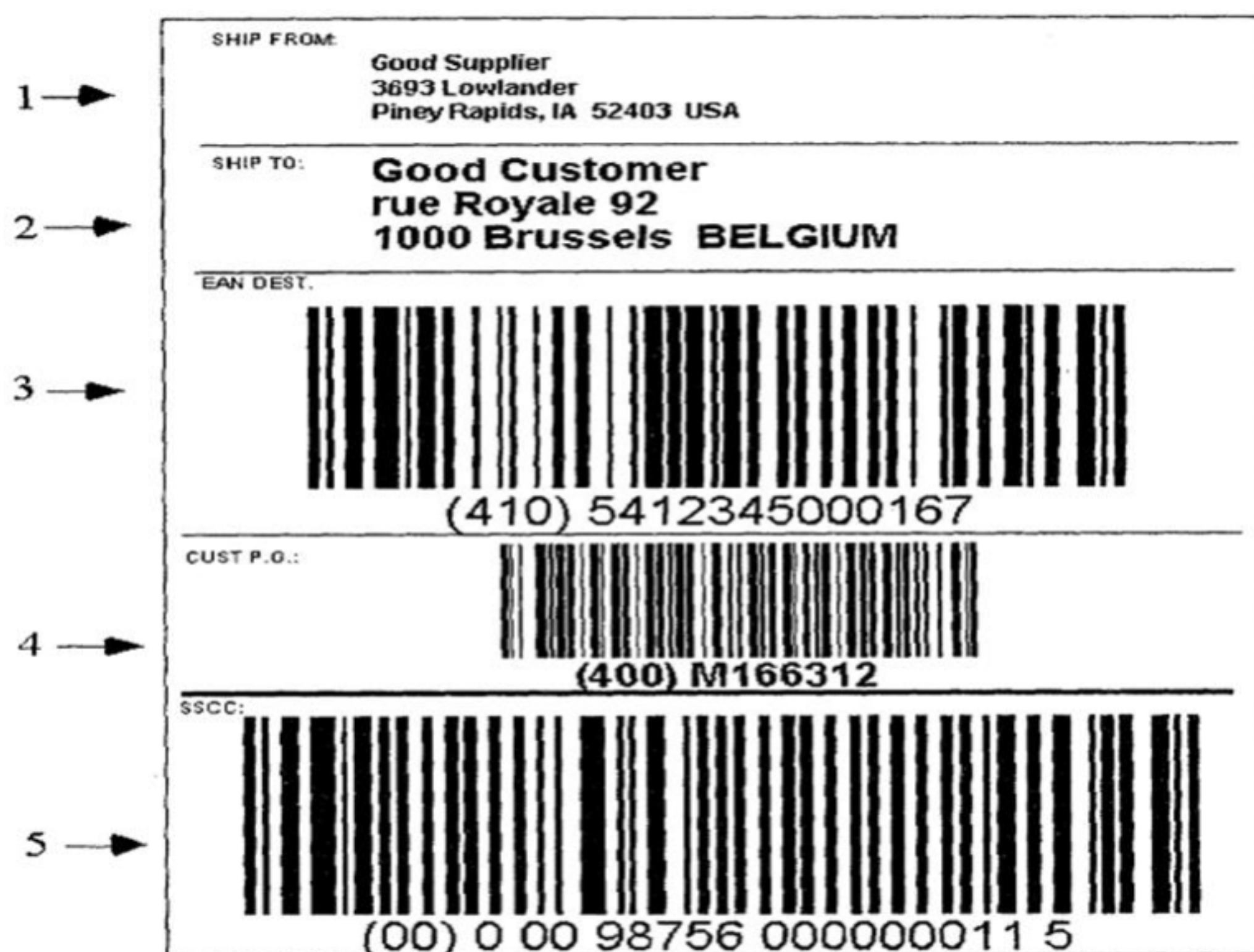
Рис. 2.10. Основная этикетка, содержащая уникальный идентификатор транспортируемой единицы в символике UCC/EAN и ссылки к базам данных перевозчика и заказчика: 1 – текстовая информация об отправителе; 2 – текстовая информация о получателе; 3 – ссылка к базе данных перевозчика (идентификатор применения 410 – доставить получателю с последующим кодом); 4 – ссылка к базе данных получателя (400 – номер заказа); 5 – уникальный идентификатор транспортируемой единицы.
