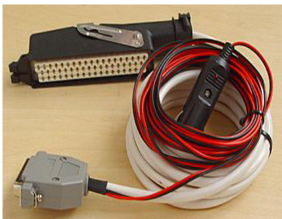
Рис. 6. Кабель для соединения адаптера с разъемами ЭБУ, имеющими 55 контактов.
