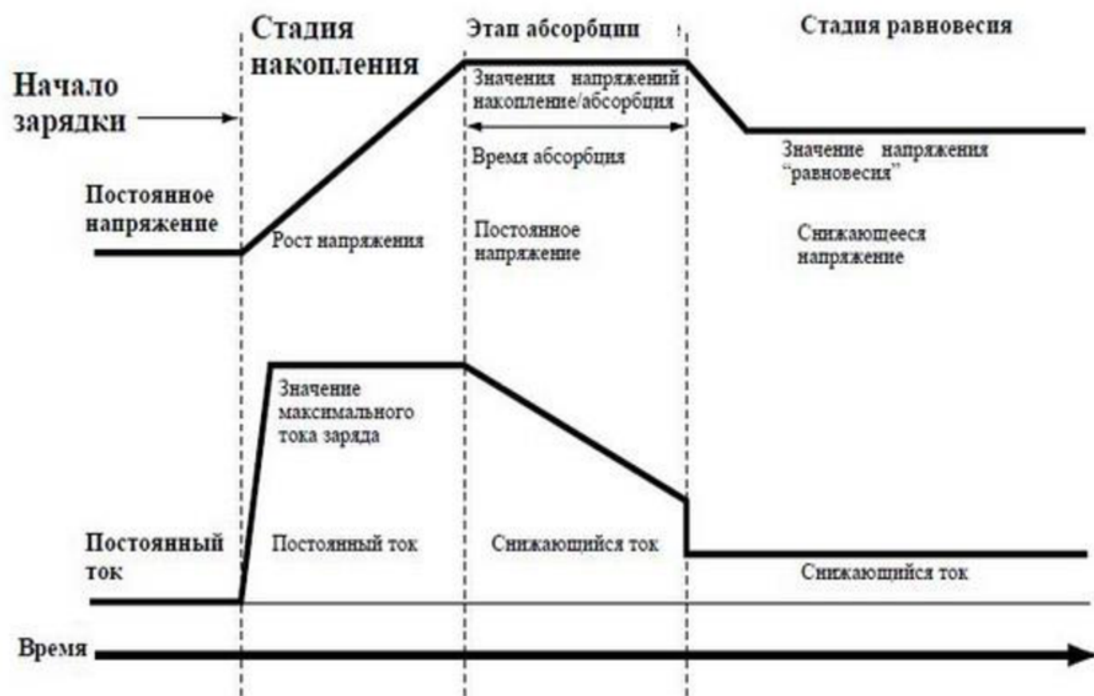
Рисунок 12 – Стадии управления зарядки АКБ
