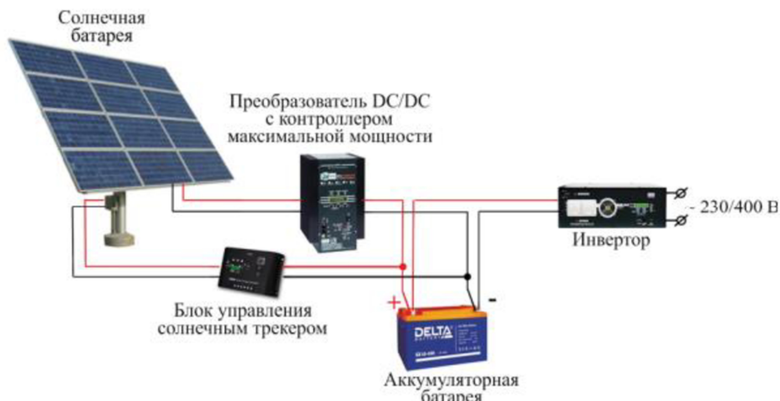
Рисунок 14 – Модель фотоэлектрической солнечной электростанции
