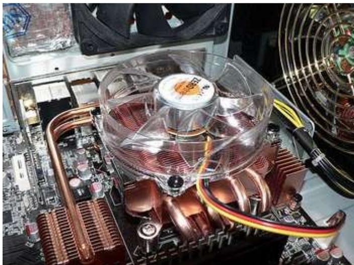
Вентиляторы, установленные в корпусе системного блока компьютера, обеспечивают общую вентиляцию в корпусе, поступление холодного воздуха и вывод горячего наружу. Тем самым происходит общее понижение температуры внутри корпуса.
