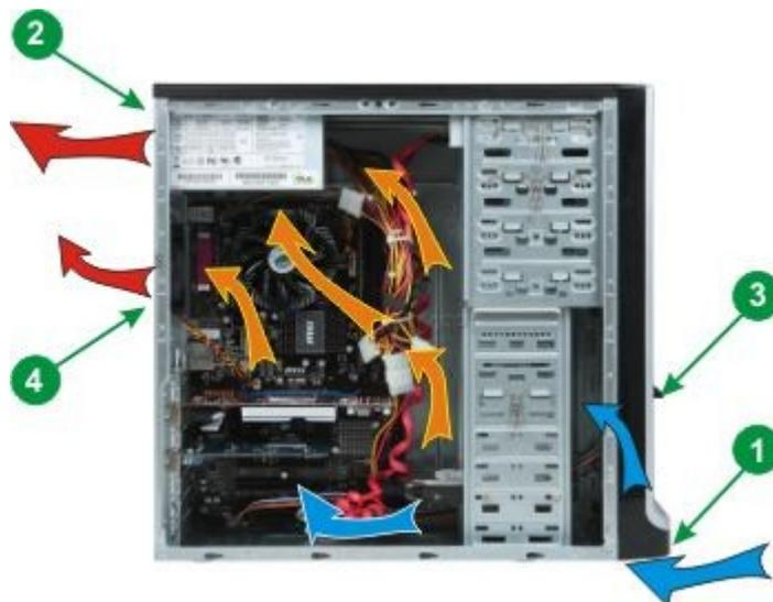
Холодный воздух подается в корпус из передней нижней части (1). Это нужно учитывать и при чистке компьютера от пыли. Нужно обязательно пропылесосить место, где засасывается воздух внутрь компьютера. Воздушный поток постепенно нагреваясь поднимается вверх и в верхней задней части корпуса выдувается через блок питания (2) уже горячий воздух.
