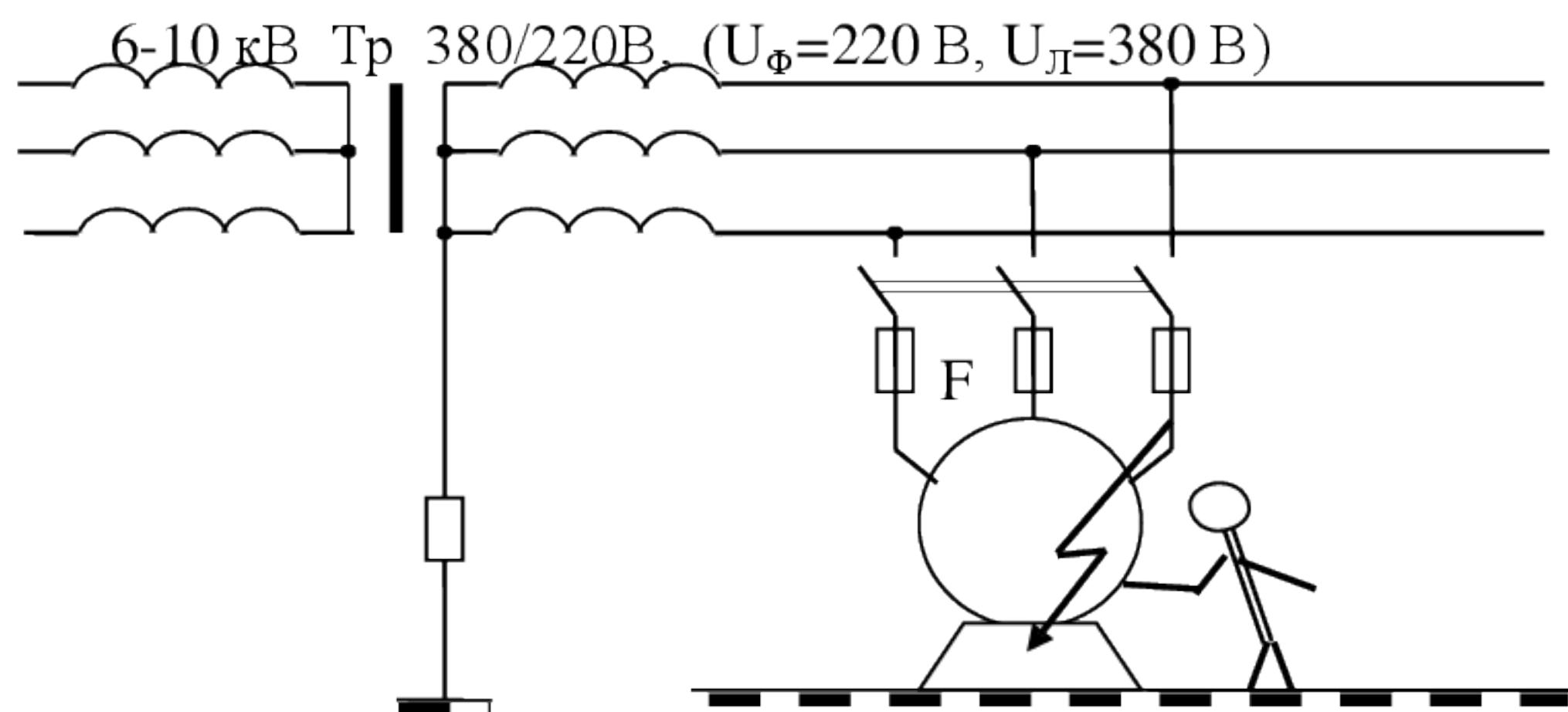
Рис. 6.2 – Прикосновение человека к фазному проводу трехфазной электрической сети с глохом заземленной нейтралью
