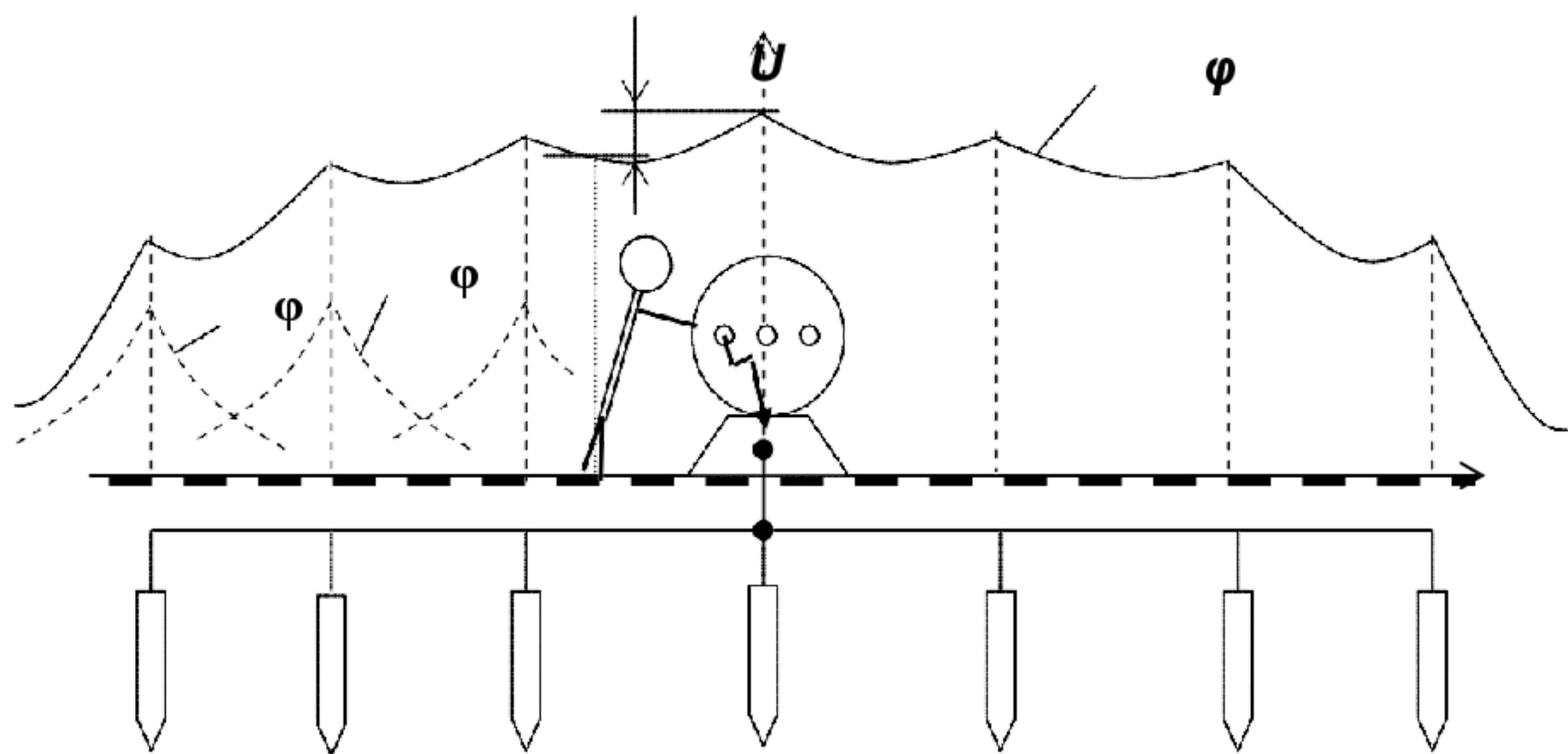
Рис. 6.4 – Случай контурного (распределенного) заземлителя
