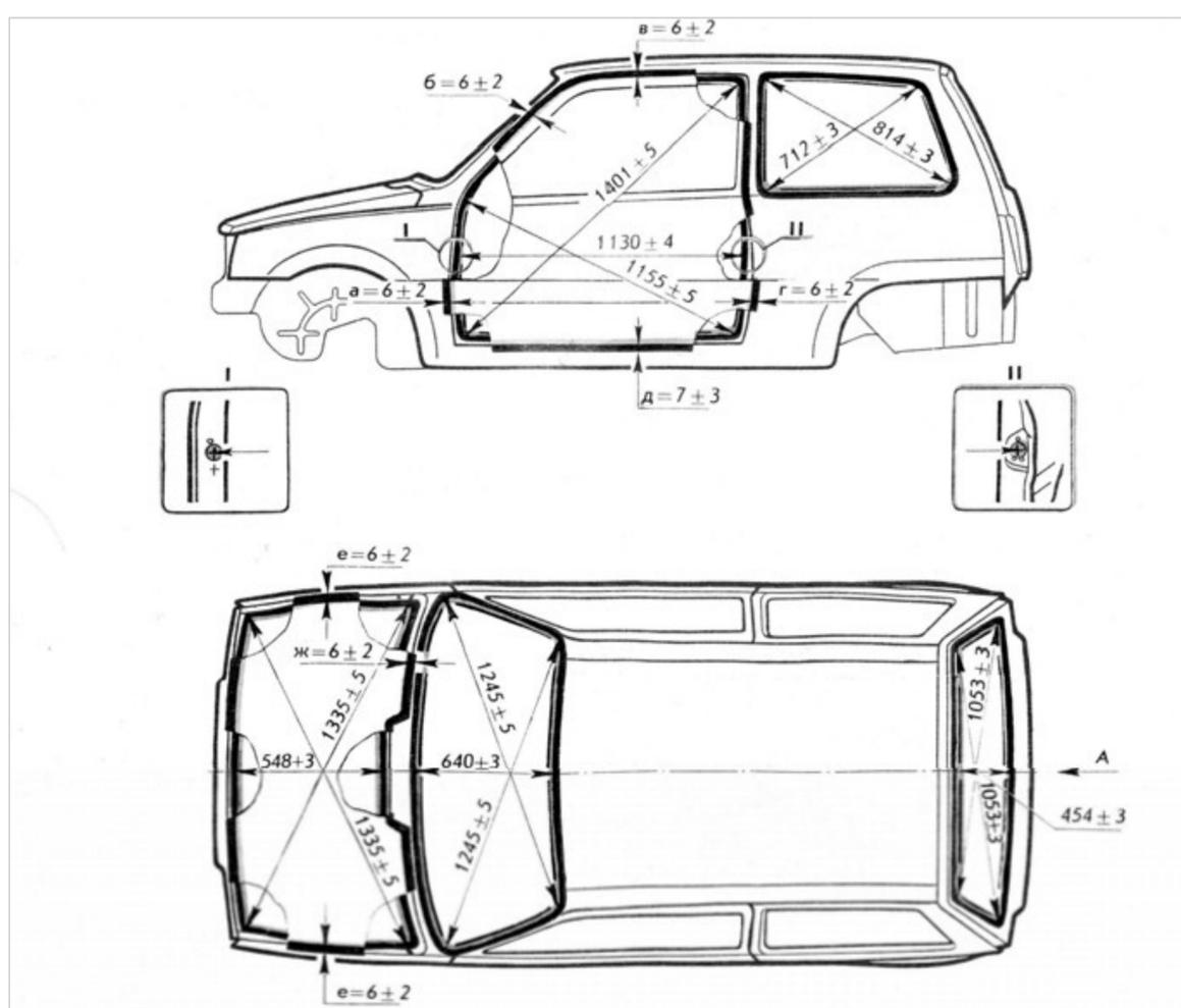
Рис. 9. Размеры проемов и зазоры спрягаемых деталей кузова автомобиля модели
