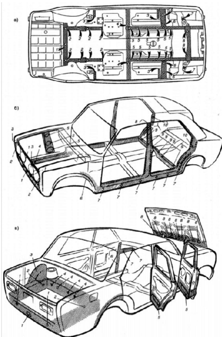
Рис. 19. Скрытые полости кузова автомобиля ВАЗ-2106:
