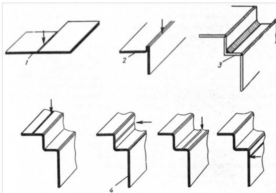
Рис. 6. Подготовка кромок тонких листов под сварку:
