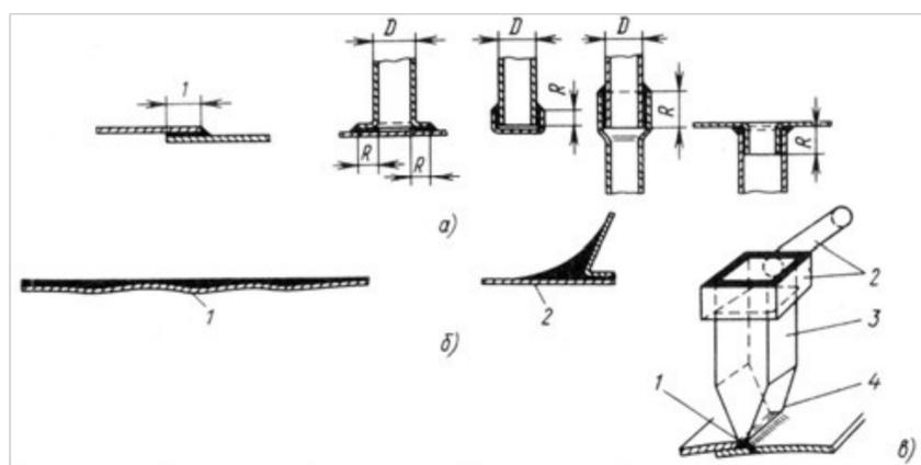
Рис. 3. Пайка оловянным припоем:
