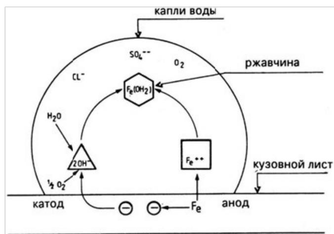
Рис. 18. Схематичное изображение процесса коррозии
