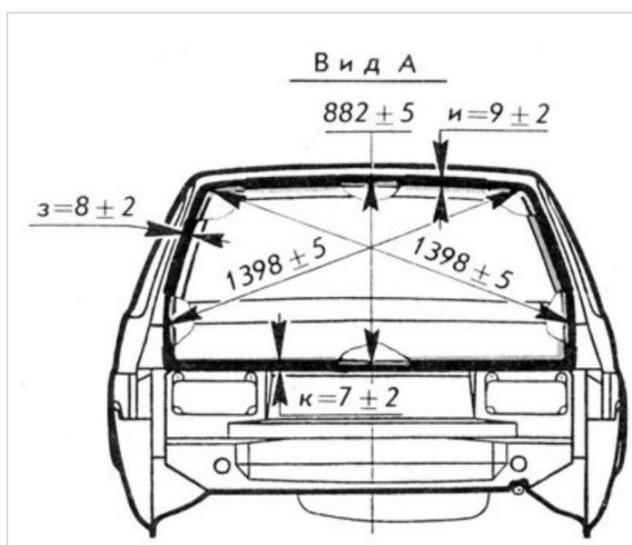
Рис. 8. Размеры проемов и зазоры сопрягаемых деталей кузова автомобилей моделей ВАЗ-2108, ВАЗ-2109
