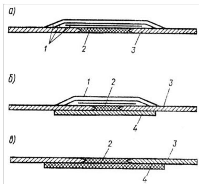
Рис. 1. Варианты устранения сквозных повреждений в панелях кузова путем установки накладок из стеклоткани:
