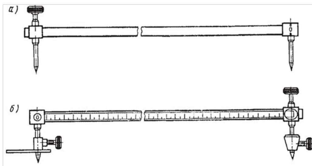
Рис. 5. Линейки для контроля проемов кузова:
