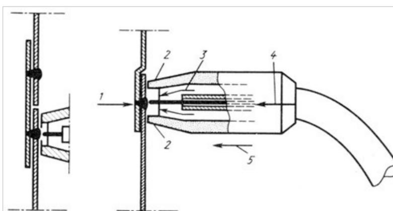
Рис. 12. Точечная сварка тонких листов, один из которых выполнен с накладной лентой, а другой с отбортовкой:
