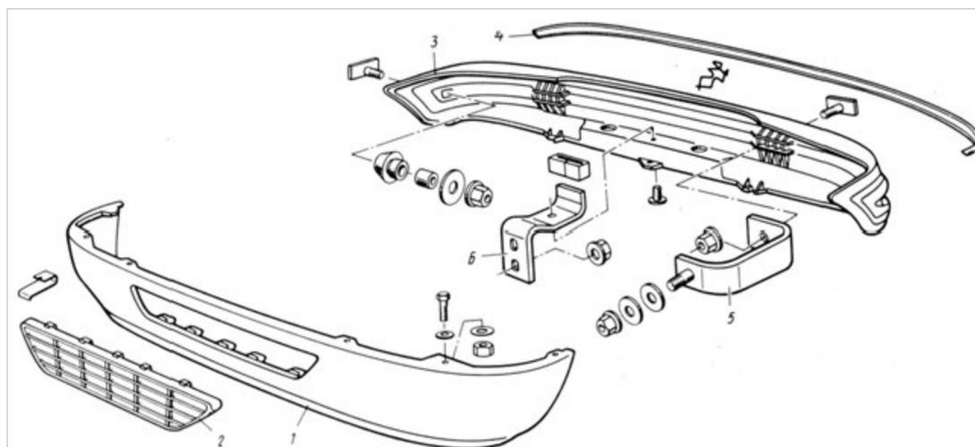
Рис. 18. Щитки из композиционных материалов автомобиля:
