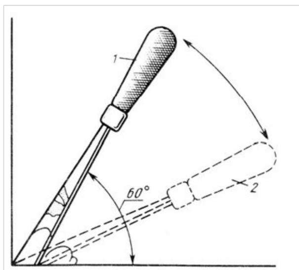
Рис. 15. Положение шпателя при шпатлевании:
