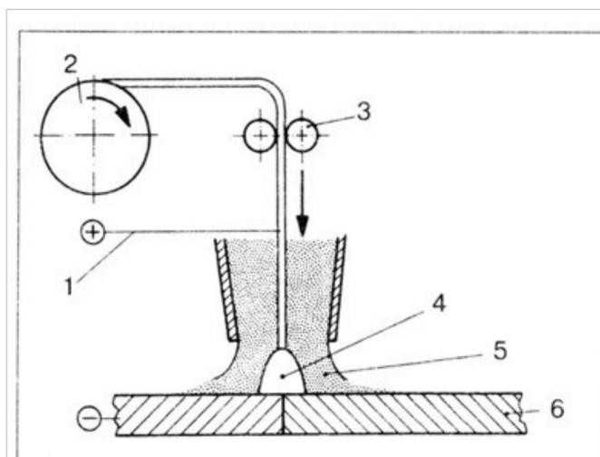
Рис. 9. Схема процесса сварки в среде защитного газа: 1 – электрод; 2 – катушка с проволочным электродом; 3 – механизм подачи проволочного электрода; 4 – электрическая дуга; 5 – защитный газ; 6 - деталь
