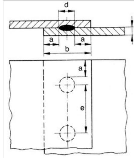
Рис. 14. Геометрические параметры контактно точечной сварки:
