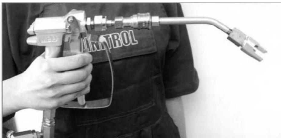
Рис. 21. Пистолет для безвоздушного распыления
