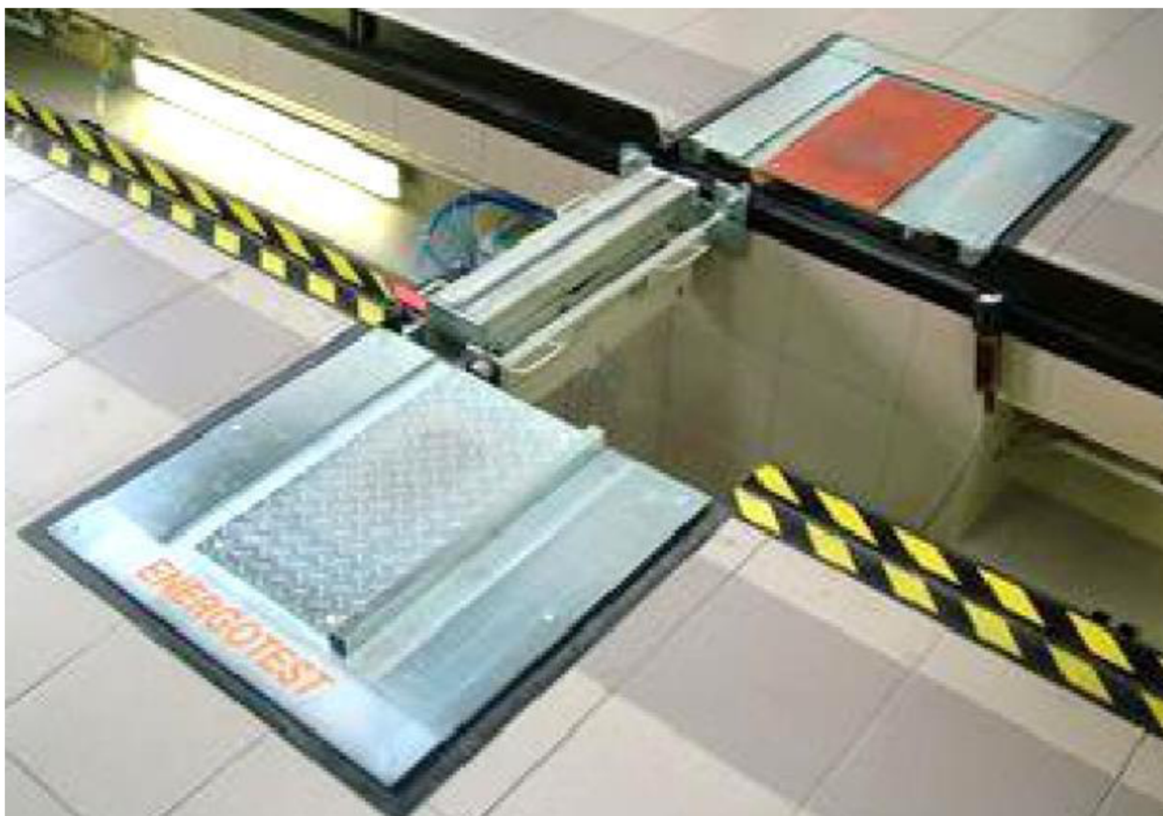
Рисунок 7. Общий вид детектора люфтов в подвеске автомобиля
