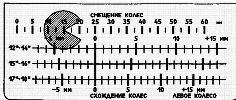
Рисунок 12 – Схема шкалы правого измерительного прибора
