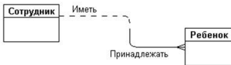
Рис. 2. Пример связи между сущностями Связь может иметь один из следующих типов :
