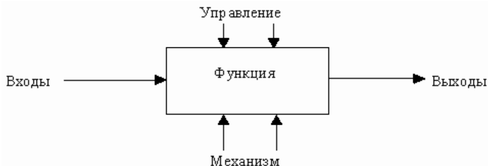
Рис. 1. Функциональный блок и интерфейсные дуги
