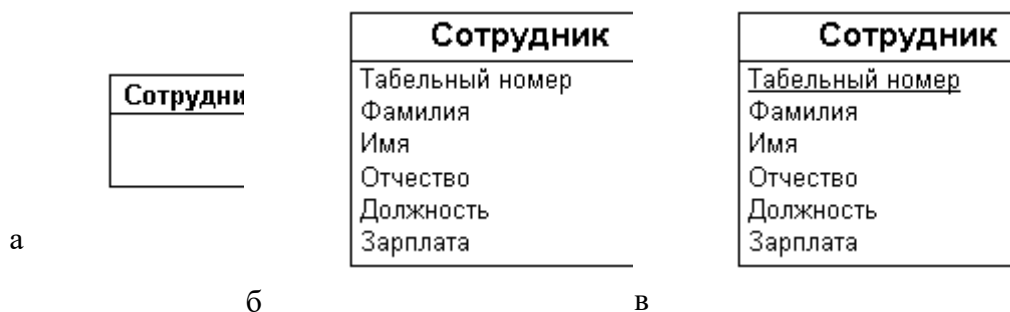
Рис. 1. Обозначения сущности в нотации Баркера:
