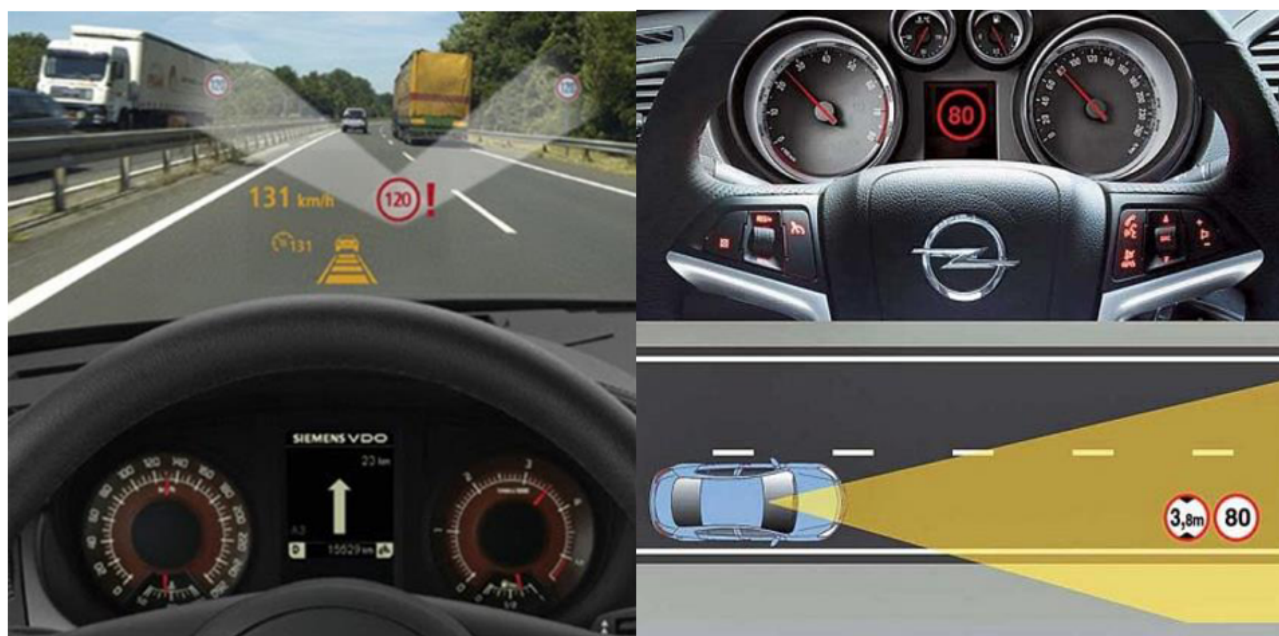
Рисунок 13 – Отображение считанной видеокамерой информации на: а – лобовое стекло; б – на панель приборов.
