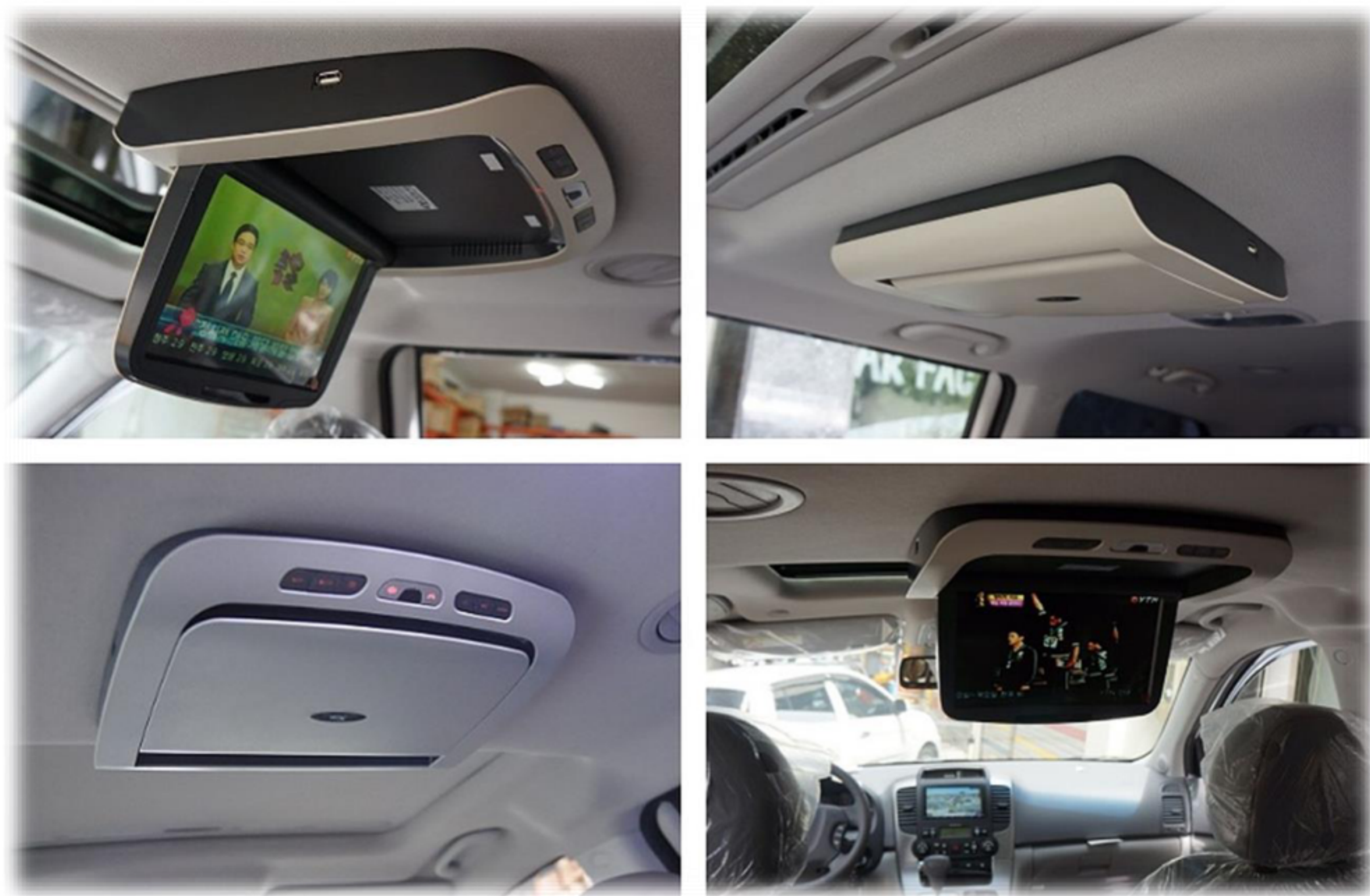
Рисунок 3 – Пример установки подвесных мониторов потолочного типа.
