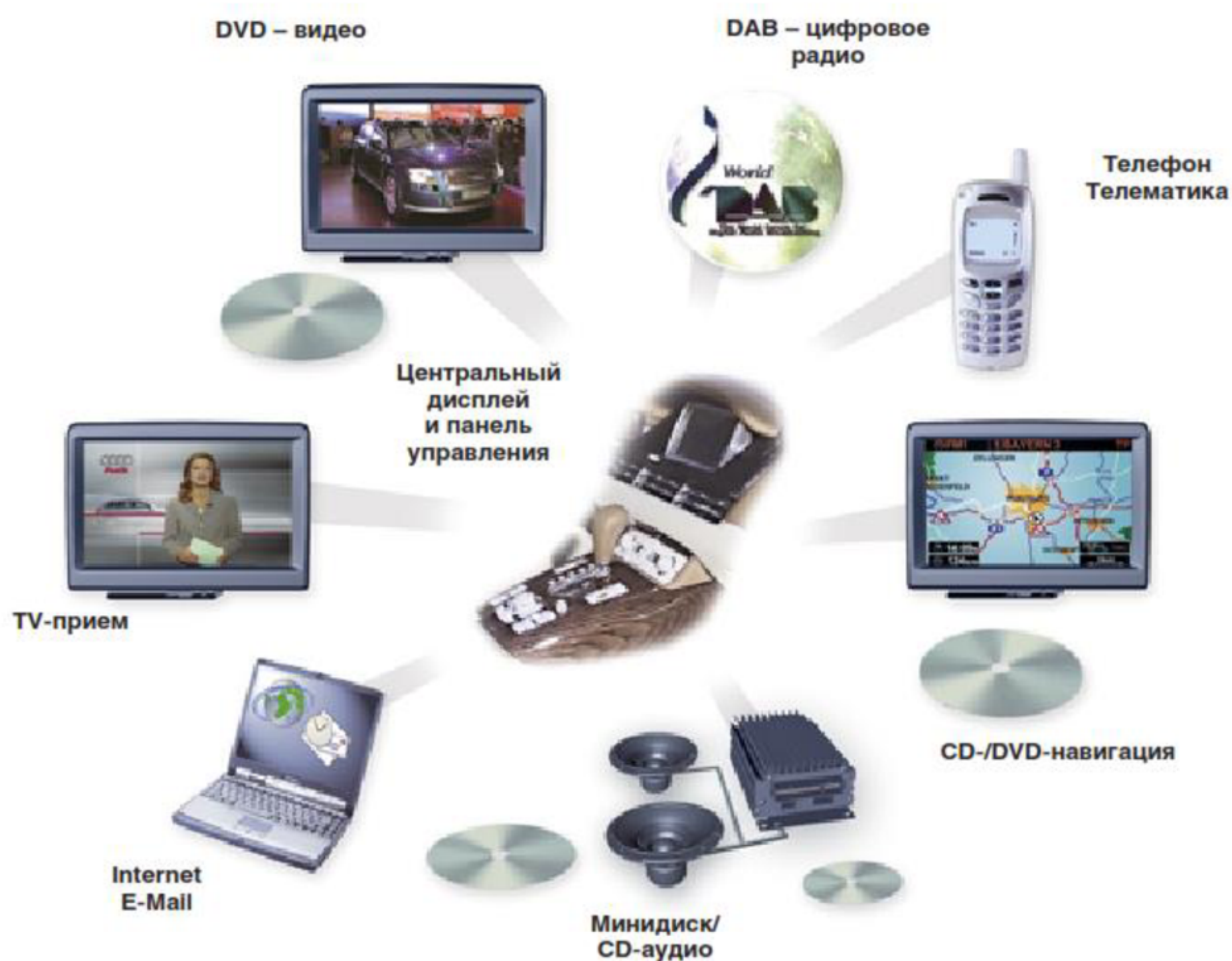
Рисунок 6 – Взаимодействие систем автомобиля по шине MOST.
