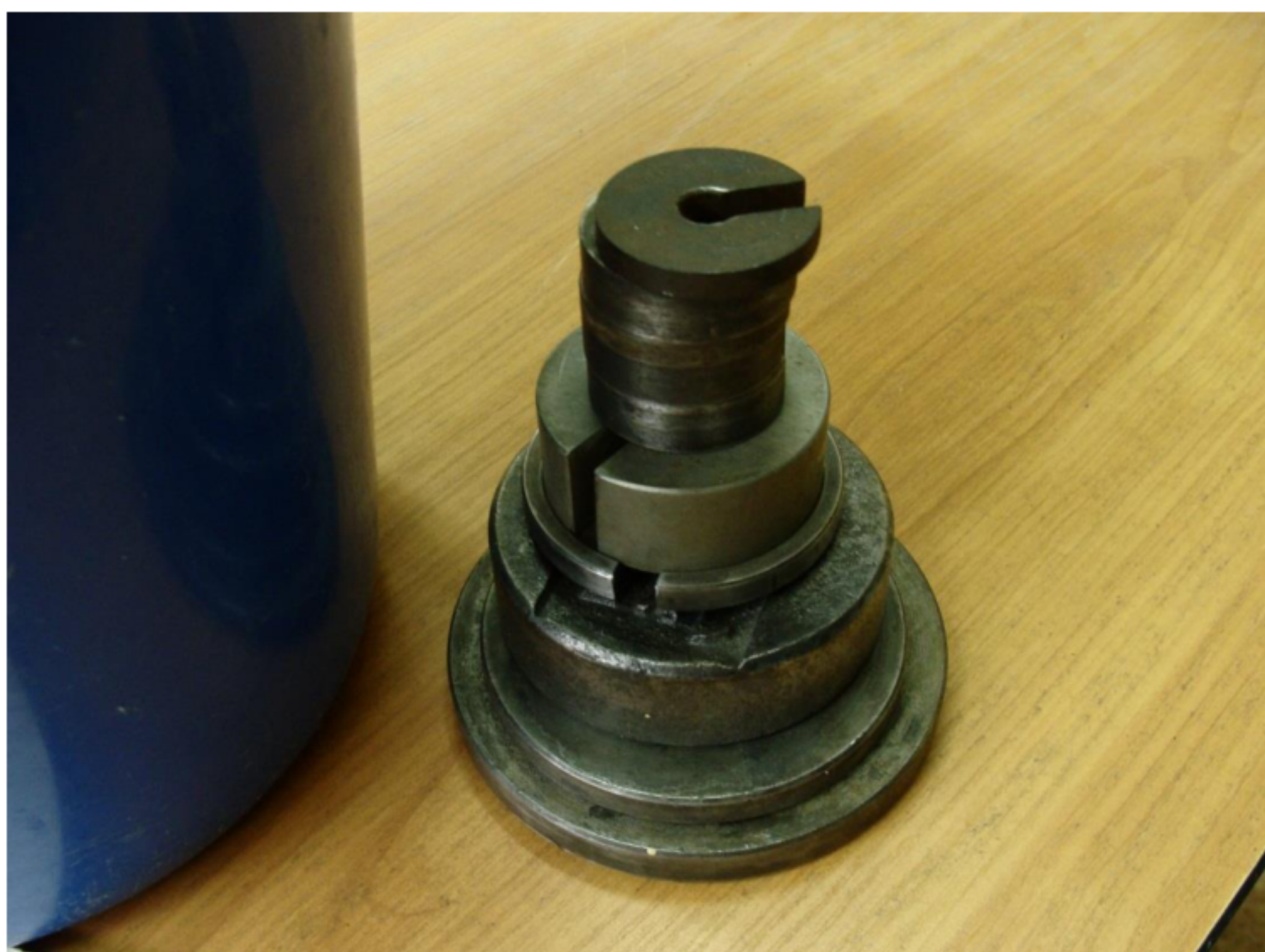
Рис. 5.6.4. Комплект разновесов для выполнения лабораторной работы
