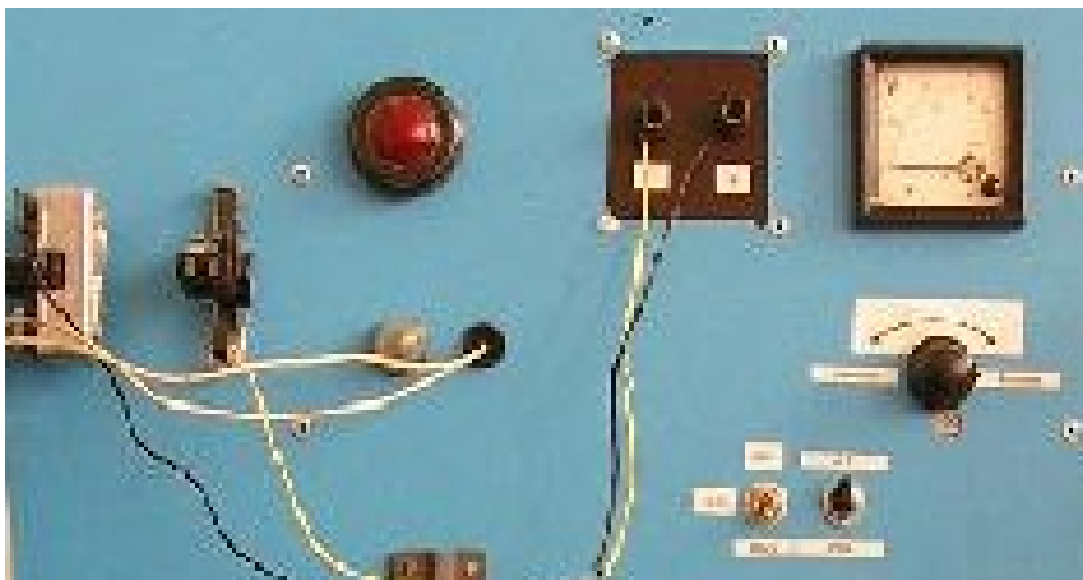
Рис. 4. Общий вид лабораторной установки для испытания регуляторов напряжения
