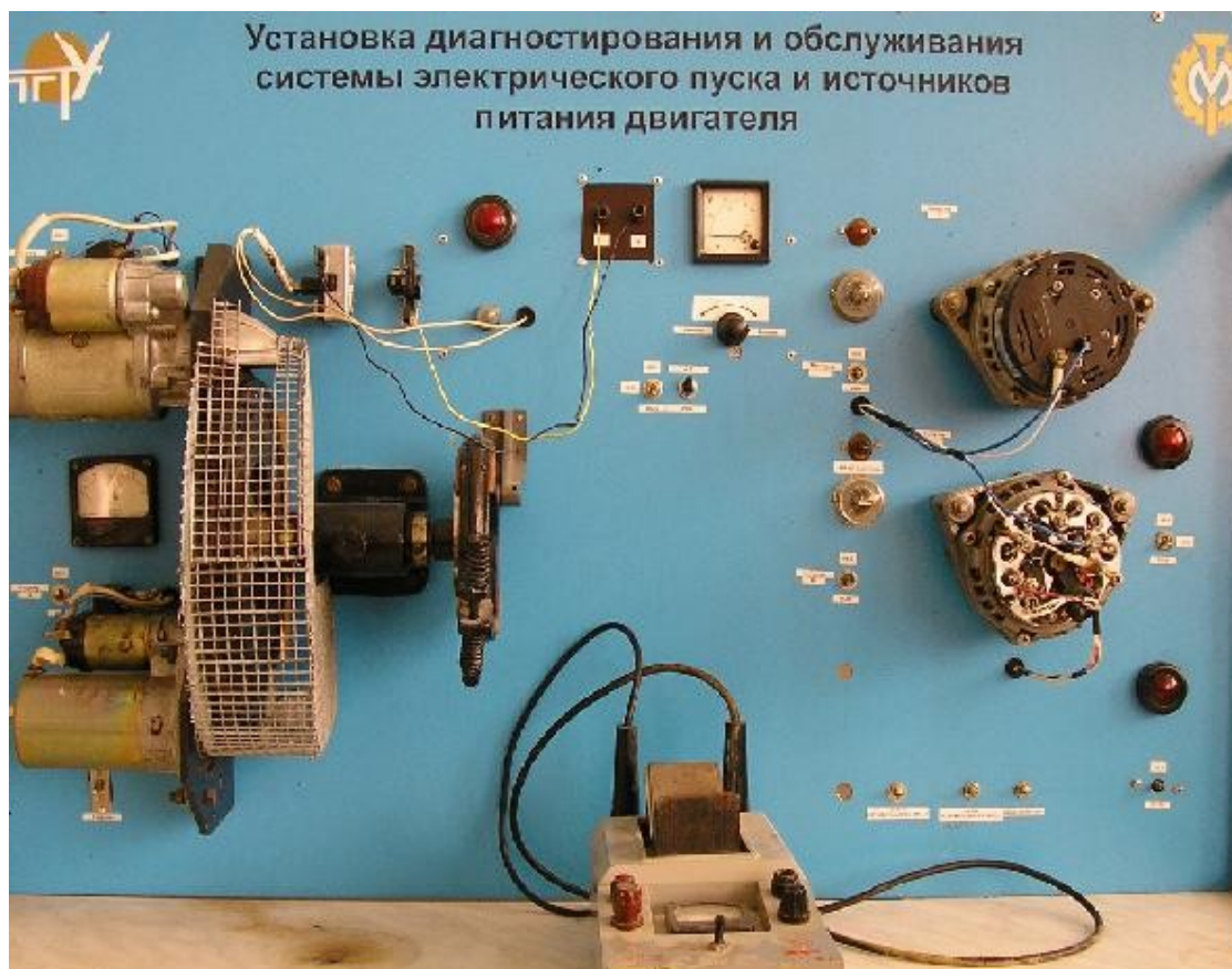
Рис. 2. Общий вид лабораторной установки для испытания генераторов
