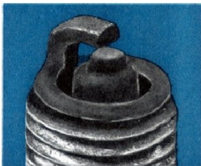
в - закопченная свеча
