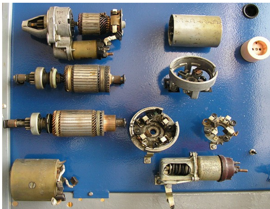
Рис. 4. Лабораторная установка для диагностирования элементов стартерных установок
