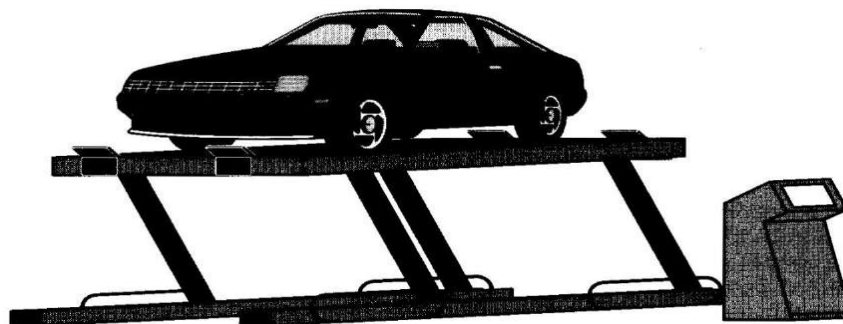
Рис. 5.12. Параллелограммный подъемник для легковых автомобилей
