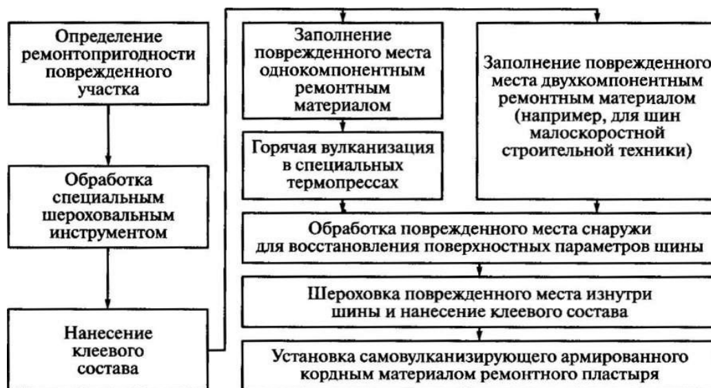
Рис. 6.8. Основные этапы ремонта сквозных повреждений шин
