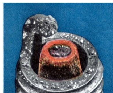
г - замасленная свеча
