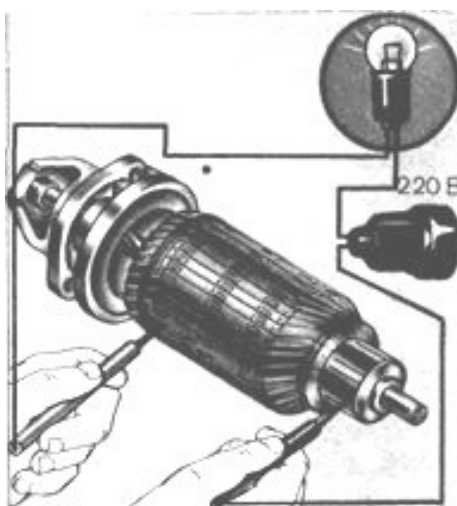
Рис. 8. Испытание обмоток ротора на замыкание с корпусом.
