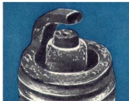
г - замасленная свеча
