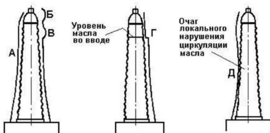
Рисунок 3 - Характер распределения температуры по высоте маслонаполненного ввода.
