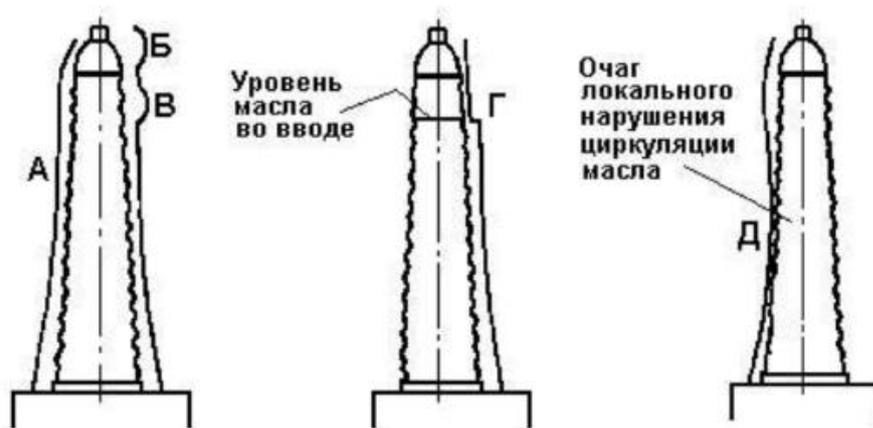
Рисунок 3 - Характер распределения температуры по высоте маслonaполненного ввода.
