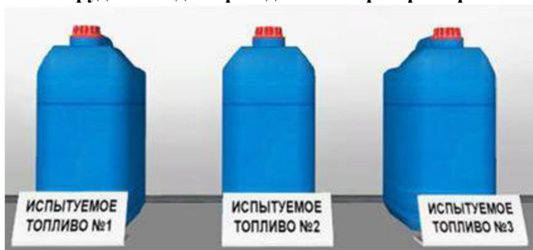
Рис. 3.3. Канистры с образцами топлива (плотность: бензин - 0,69-0,75; дизельное топливо - 0,821-0,86; реактивное топливо - 0,751-0,82)
