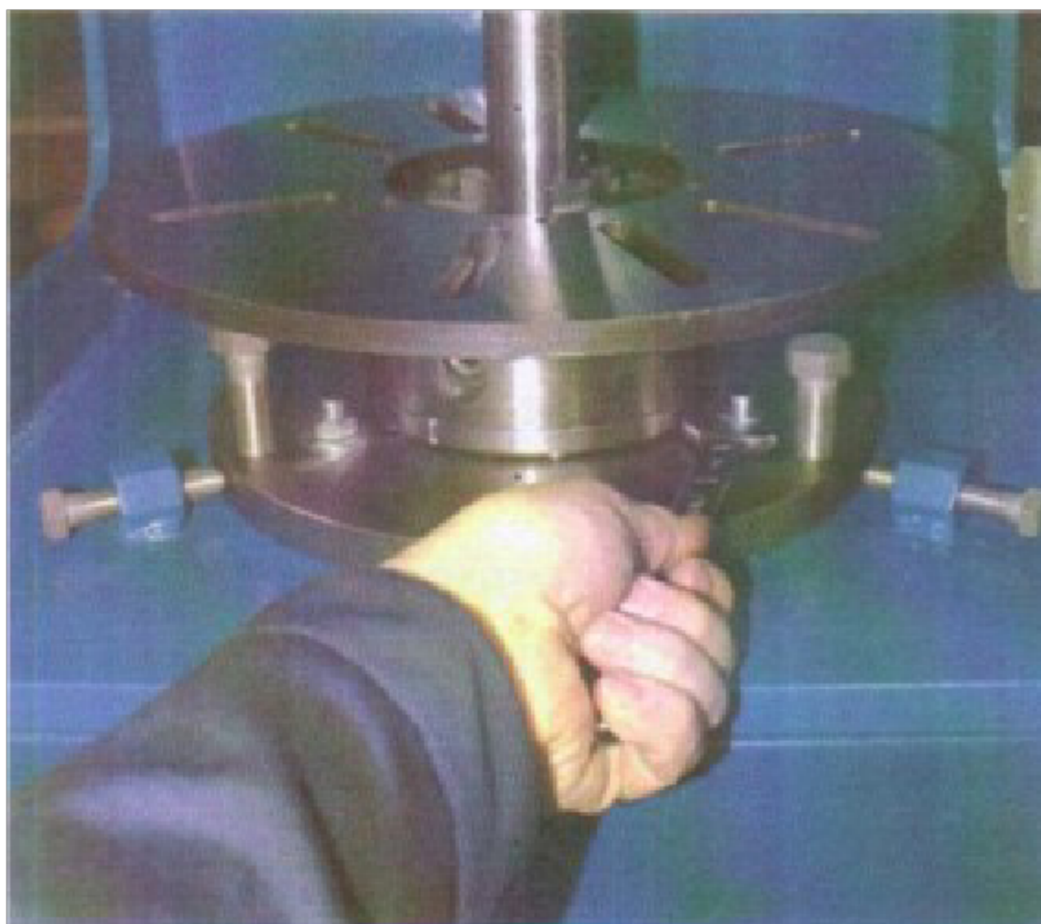
Рисунок 15 - Прижимные болты для фиксации настроек.
