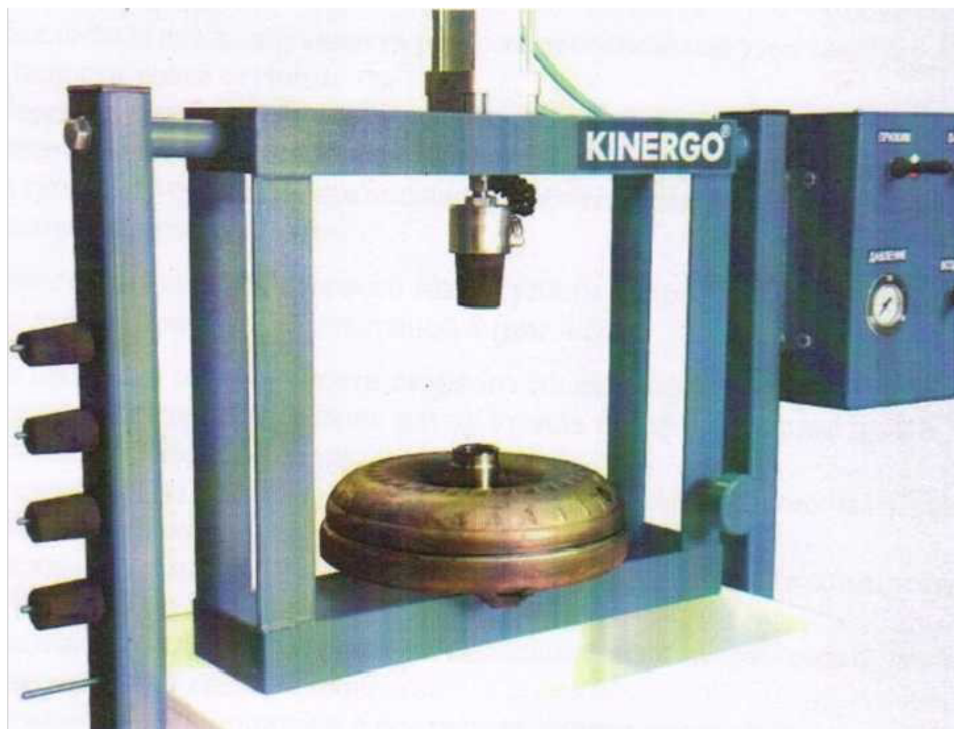
Рисунок 3 - Установка гидротрансформатора на основание.
