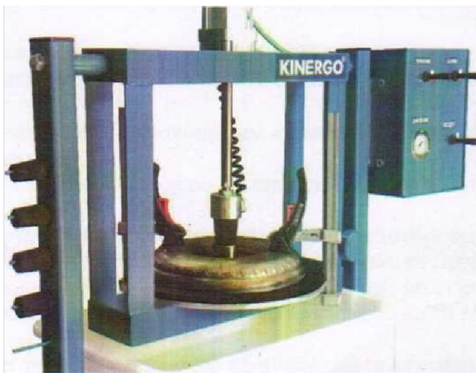
Рисунок 5 – Проверка герметичности соединения гидротрансформатора
