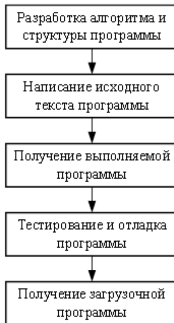
Рис. 5. Последовательность разработки ПО для микроконтроллеров
