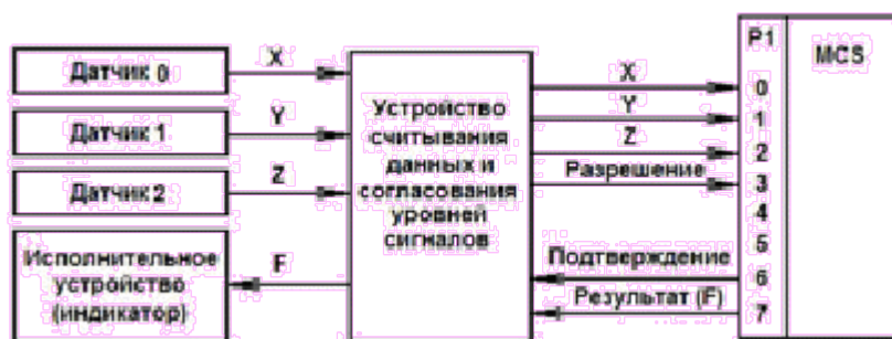
Рис. 26.1. Структурная схема микропроцессорной системы обработки битовой информации
