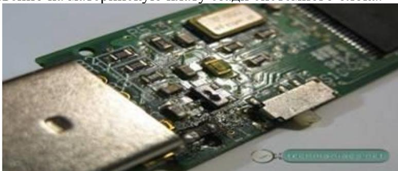
Рисунок 4 - Внешний вид флэш-накопителя со сгоревшим стабилизатором
