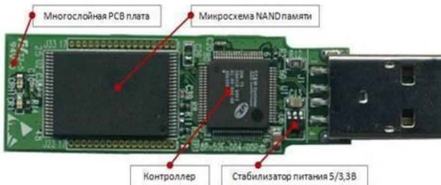
Рисунок 1 - Расположение основных элементов флэш-накопителя
