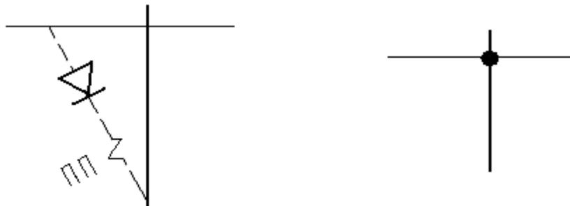
Рисунок 2. Обозначение соединения диодом.
