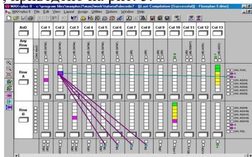
Рис. 5. Изображение конфигурации ПЛИС типа LABView
