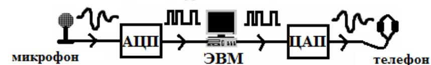
последовательность двоичных чисел. Для преобразования аналогового сигнала в цифровой используется специальный конвертор, называемый аналогово-цифровой преобразователь (АЦП). В англоязычной литературе используется термин Analog Digital Converter (ADC). Сигнал на выходе АЦП представляет собой последовательность двоичных чисел, которая может быть обработана компьютером. Обратная конверсия цифрового сигнала в непрерывный сигнал осуществляется с помощью цифроаналогового преобразователя (ЦАП, DAC).
