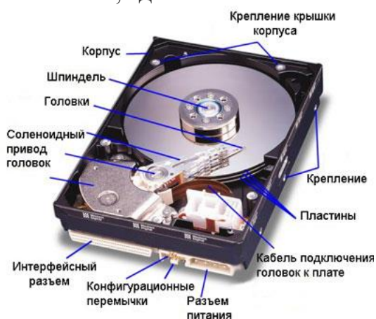
Рисунок 2 - Устройство НЖМД
