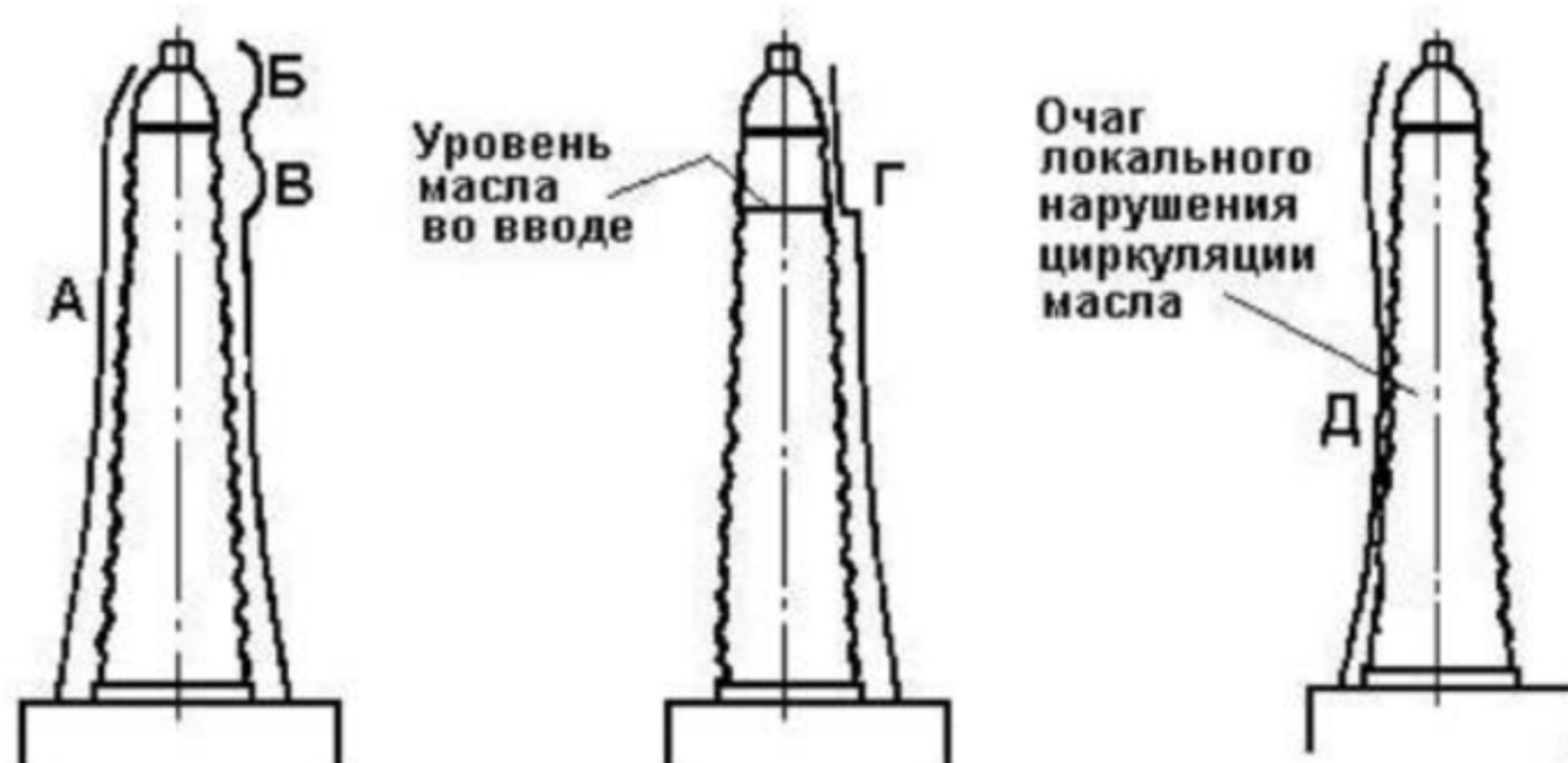
Рисунок 3 - Характер распределения температуры по высоте маслonaполненного ввода.
