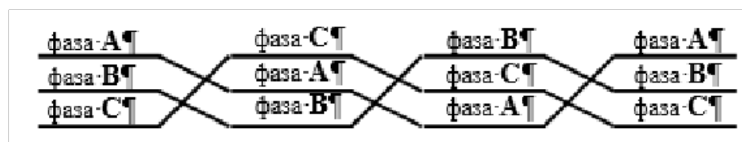
Рисунок 16.3 – Транспозиция на ВЛЭП
