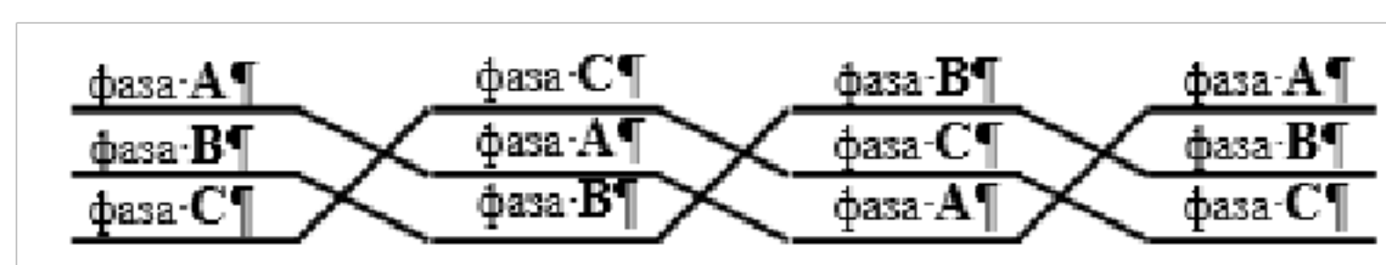
Рисунок 16.3 – Транспозиция на ВЛЭП
