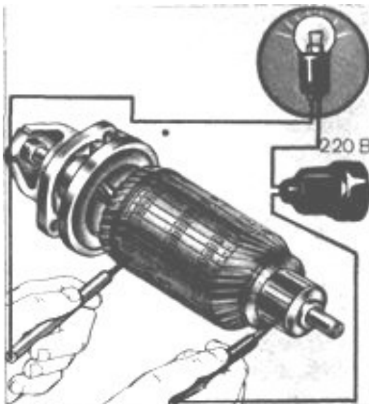
Рис. 25. Испытание обмоток ротора на замыкание с корпусом.
