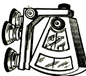
Рис. 1 - Деселерометр маятникового типа
