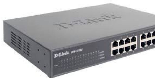
Рис. 7. Концентратор с фиксированным количеством портов
