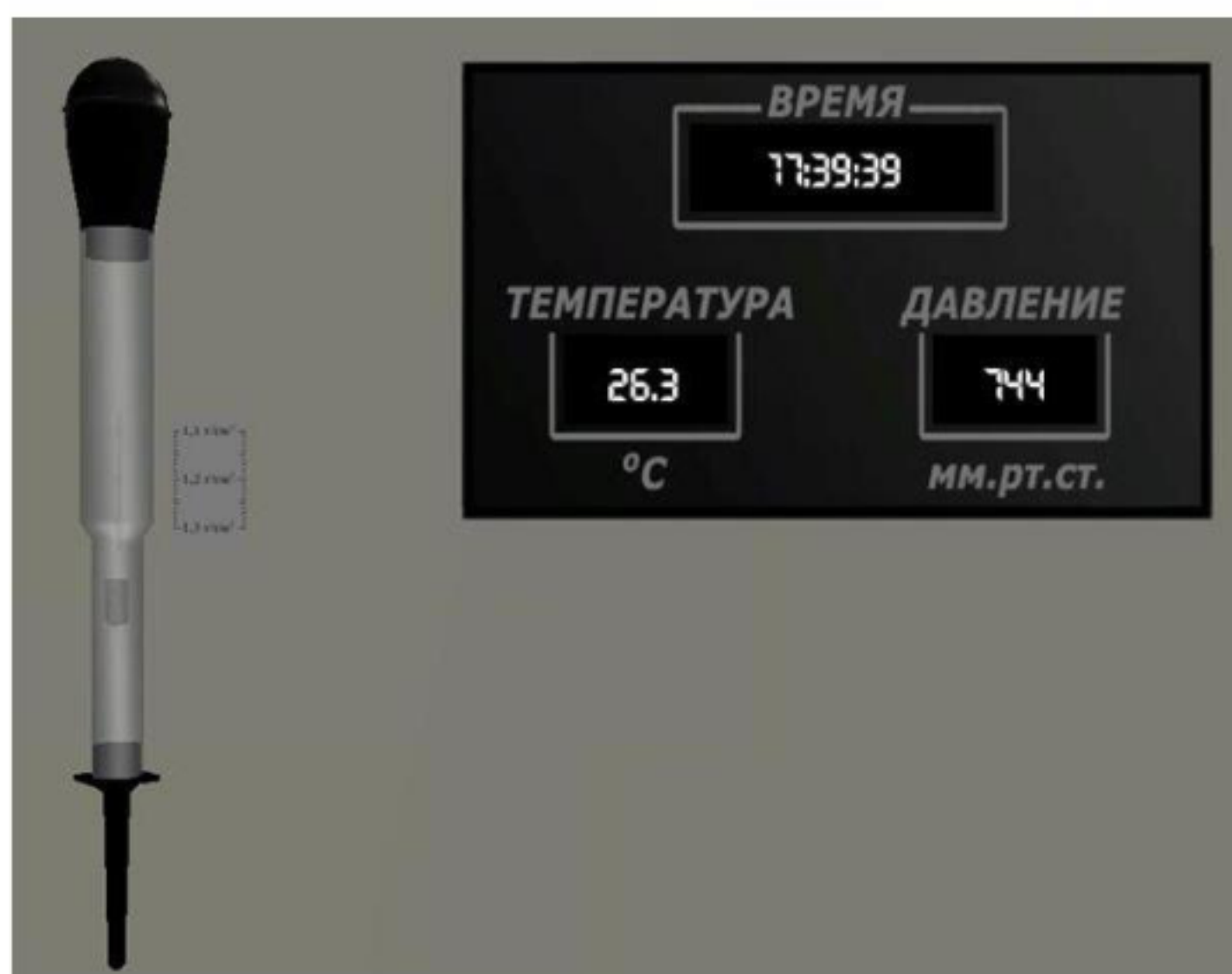
Рис. 4.1. Денсиметр после замера плотности электролита
