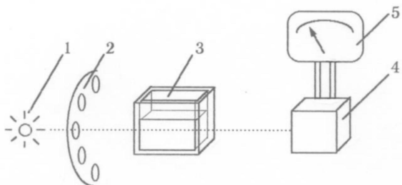
Луч света от источника (1) проходит через светофильтр (2) и попадает в кювету с исследуемым раствором (3). В растворе часть светового потока поглощается. Ослабленный луч попадает на фотоэлемент (4), преобразующий световой сигнал в электрический, который передается на показывающий прибор (5).
