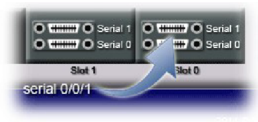
Рис. 14. Выбор интерфейса serial 0/0/1 на маршрутизаторе 2811 Router B
