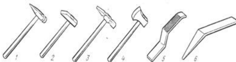
Рис.1. Молотки: 1-рихтовочный; 2-облегченного типа; 3-для загибки фланцев; 4-с выпуклой ударной частью; 5-специальный с насечкой рабочей части; 6-молоток-гладилка
