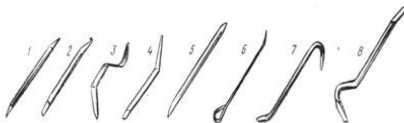
Рис.3. Рычаги и прижимы для исправления вмятин: 1-рычаг для исправления дефектов штамповки; 2-рычаг для рихтовки крыльев после окраски; 3-рычаг-прижим; 4-рычаг для исправления вмятин; 5-рычаг пластинчатый для исправления вмятин в труднодоступных местах; 6-рычаг для исправления разных дефектов; 7-рычаг для предварительной правки; 8-рычаг для устранения больших деформаций
