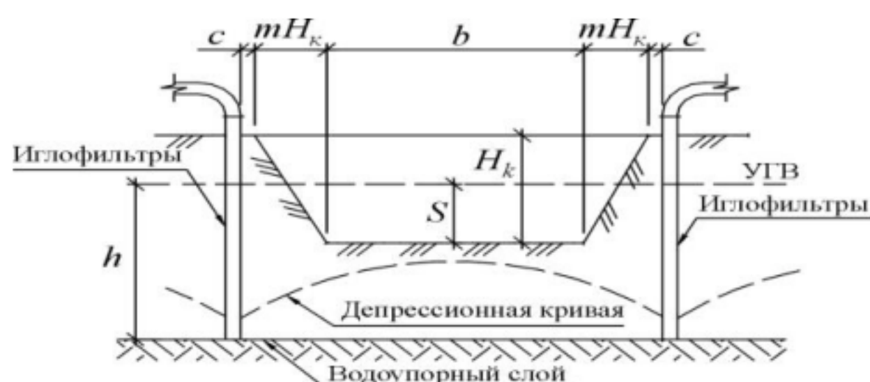
Рис. 6. Схема для расчета иглофильтровой установки
