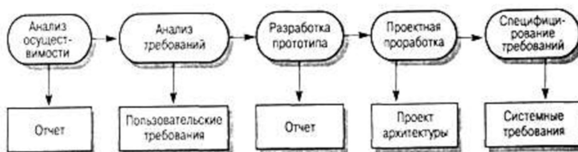
Рисунок 3.1 - Этапы процесса разработки спецификации
